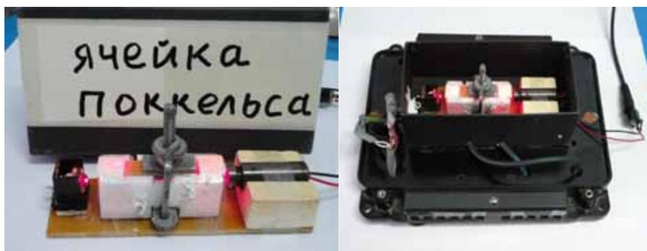
Рис. 2. Ячейка Поккельса
