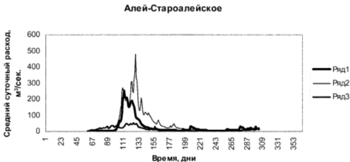
Рис. 1. Гидрографы стока Алея у с. Староалейского: 1 – год, средний по водности (1976), 2 – год, близкий к максимальному по водности (1966), 3 – год, близкий по водности к минимальному (1963)
