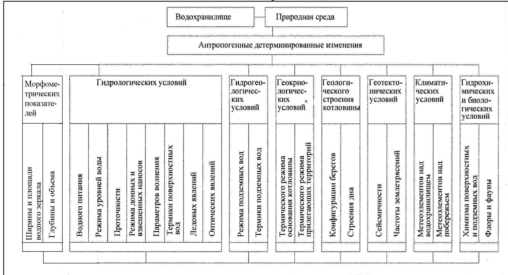
Схема изменений в природной среде, вызываемых созданием и эксплуатацией водохранилища (*касается водохранилищ, расположенных в области вечной мерзлоты)
