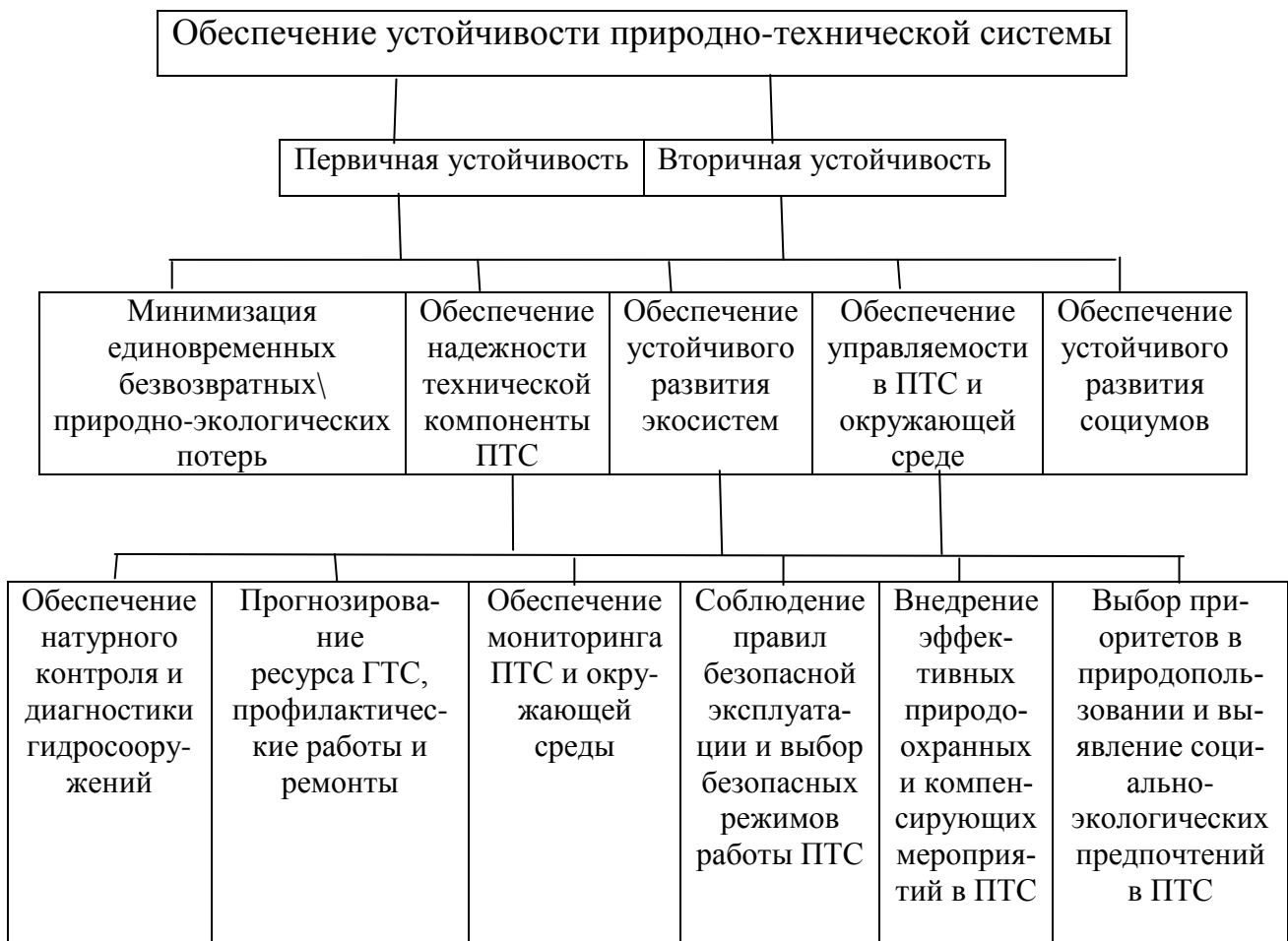
Рисунок 16.2 - Блок-схема обеспечения устойчивости ПТС
