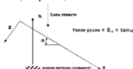
Рис. 1. Схема задания уклона русла реки.
