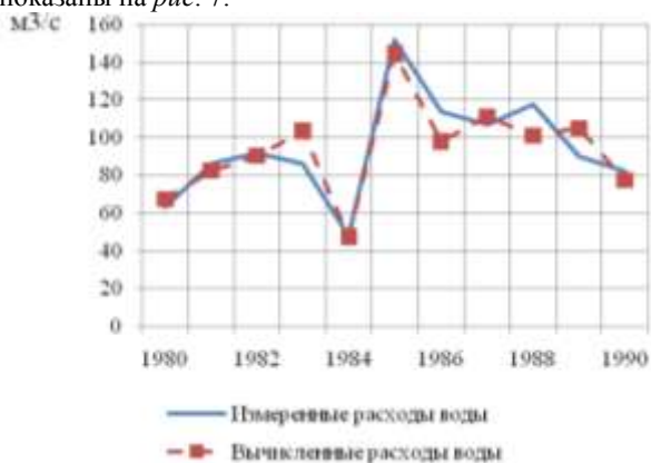
Рис. 7. Совмещенные графики измеренных и вычисленных максимальных расходов воды р. Сюрень – Миньярово (м³/с).
