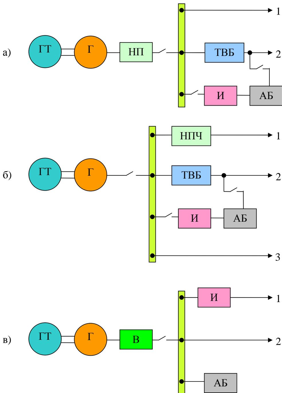
Рисунок 5 - Структурные схемы мини- и микро-ГЭС, где обозначено: ГТ – гидротурбина; Г – бесконтактный генератор, АГ или СПИМ; НПЧ – непосредственный преобразователь частоты; ТВБ – трансформаторно-выпрямительный блок; И – инвертор; АБ – аккумуляторная батарея; В – выпрямитель; 1, 2 и 3 – выходы для подключения потребителей переменного стабильной частоты, постоянного тока и переменного тока не стабильной частоты соответственно.
