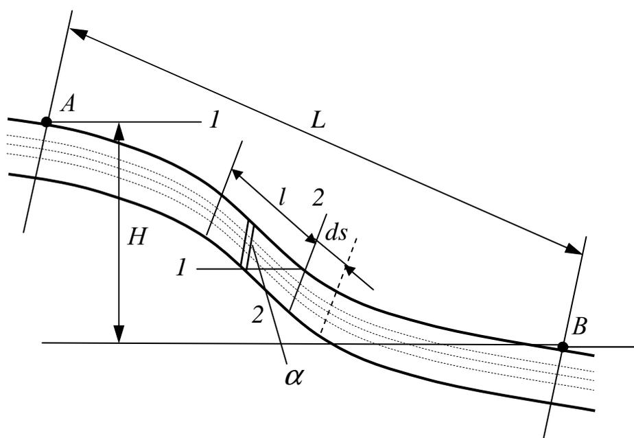
Рисунок 3 – Схема к определению мощности водного потока
