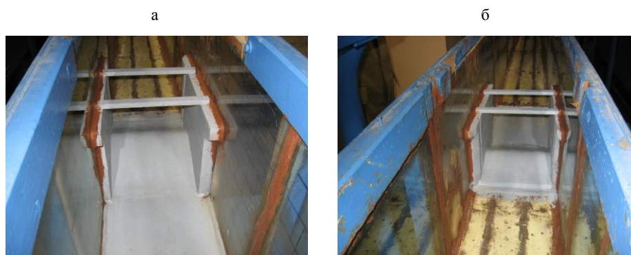
Рис. 2. Общий вид опытной установки плотины профиля Ямборга: а – с нижнего бьефа; б – с верхнего бьефа
