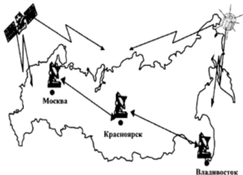
Рис. 6. Структура территориально-распределенной системы приема и обработки космической информации ФЦ ВНИИ ГОЧС
