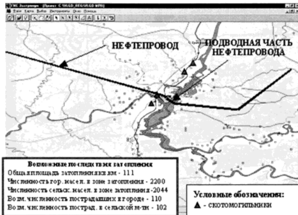
Рис. 5. Результаты прогнозирования последствий затопления с помощью ГИС «Экстремум»
