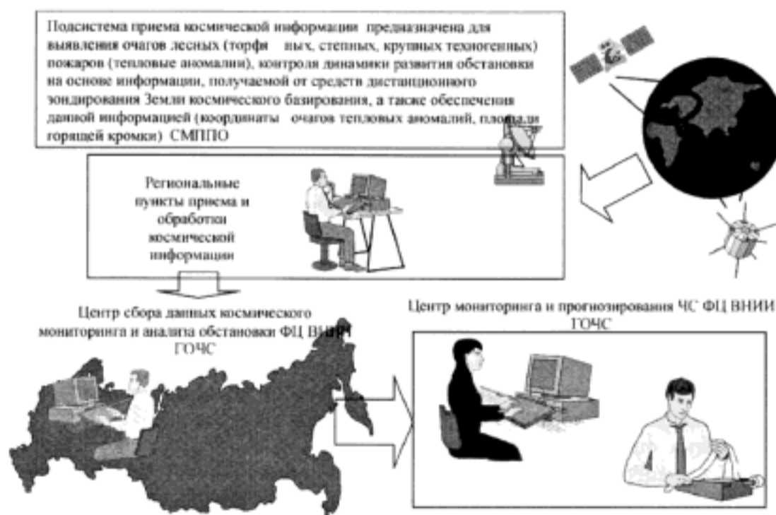
Рис. 7. Схема функционирования системы приема и обработки космической информации ФЦ ВНИИ ГОЧС
