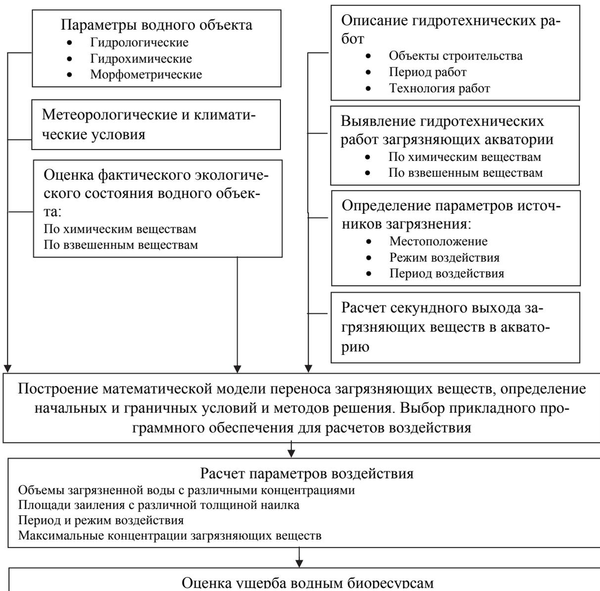
**Рисунок 1 – Функциональная модель оценки воздействия гидротехнических работ и сооружений на водные биоресурсы**
