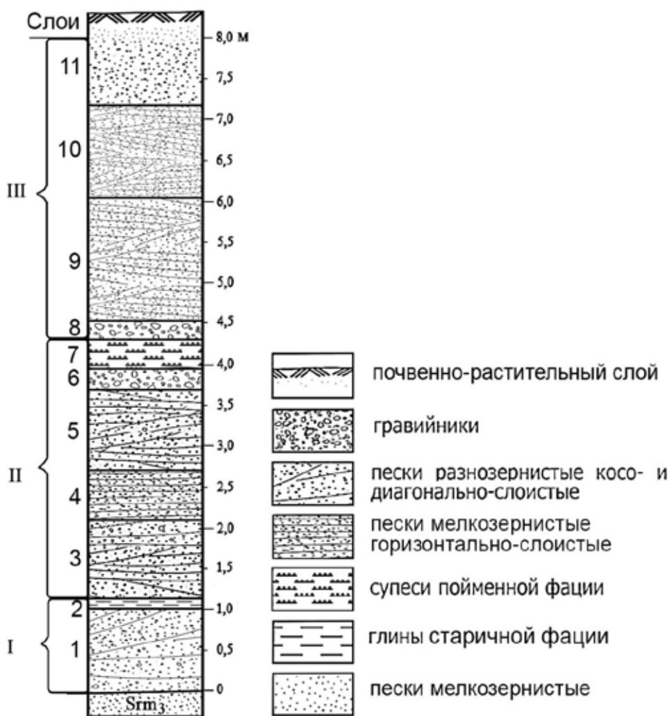
Рис. 1. Схема разреза аллювиальных отложений местонахождения Шипка-1.
