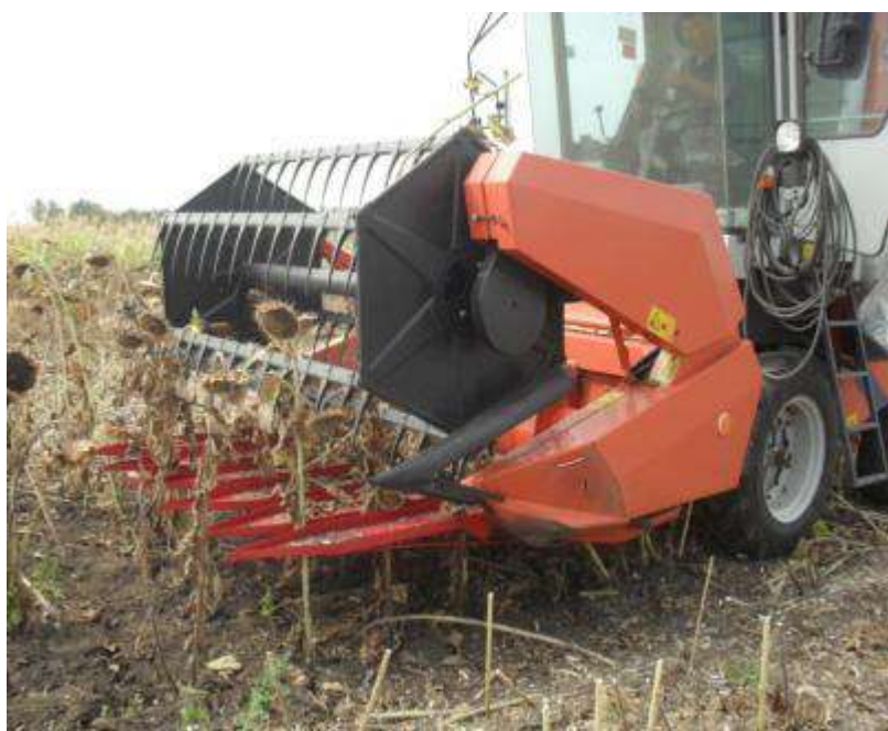
Рисунок 3 - Уборка учетных делянок переоборудованной жаткой селекционного комбайна
