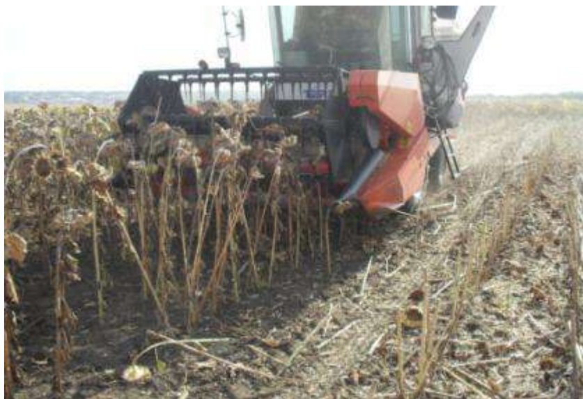
Рисунок 2 - Уборка учетных делянок штатной жаткой селекционного комбайна
