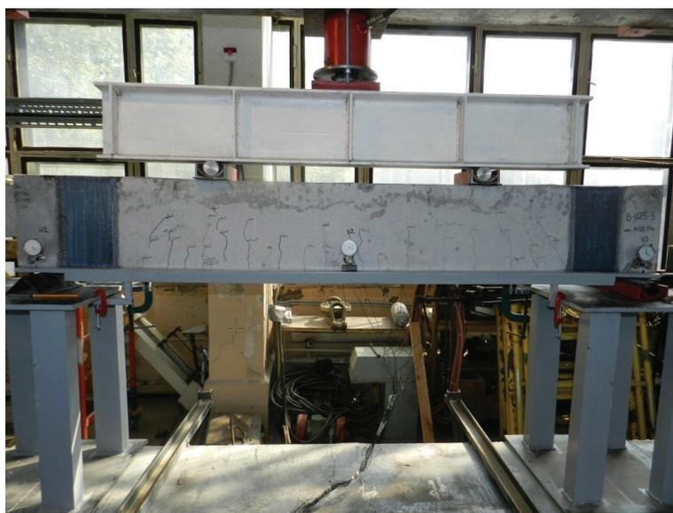
Рис. 4. Вид испытания железобетонной модели
