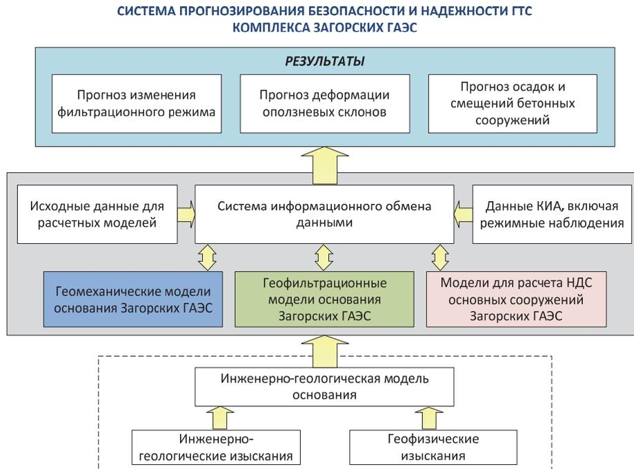
Рис. 1. Принципиальная схема программно-аппаратного комплекса (ПАК)
