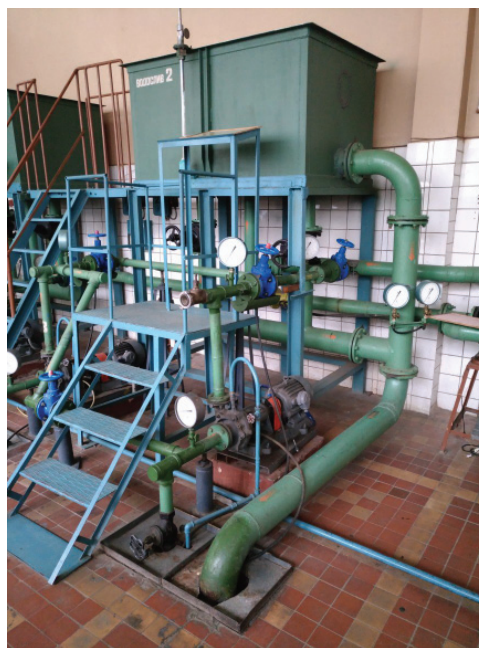
Рис. 2. Стенд для проведения параметрических испытаний центробежного насоса
