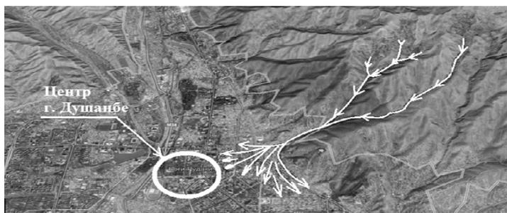
**Рис. 4. Пути движения селевых потоков из склонов кишлака Киблаи в г. Душанбе**
