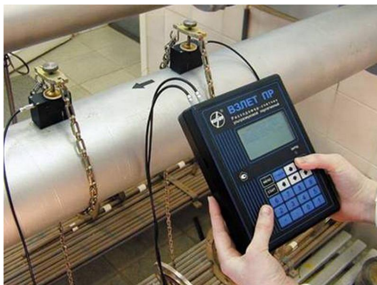
Рисунок 6 – Пример установки ультразвукового расходомера с накладными электродами
