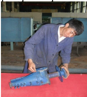
Сурет 2 – Фильтроциклонды қондырғы эксперименттер жасау үшін құрастыру сәті
