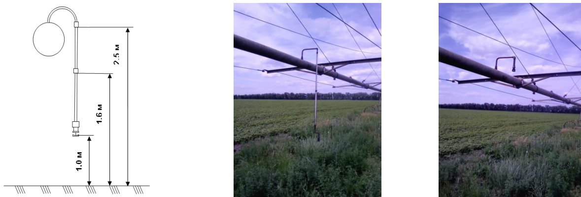
Рисунок 2 – Схема и фото устройства приповерхностного дождевания типа «сборная штанга» или «сборный рукав»
