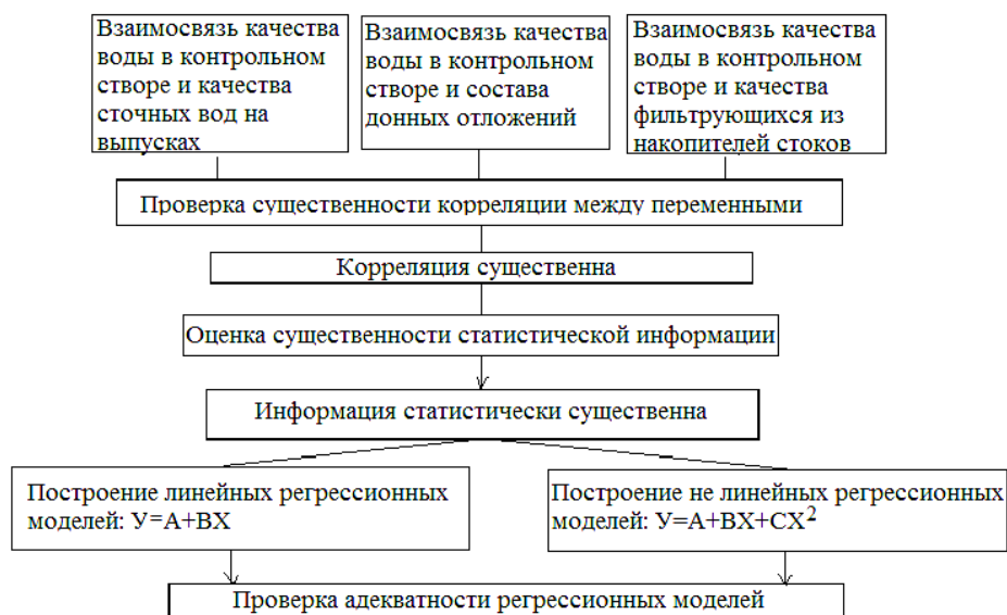
Рисунок 4 - Схема исследований при построении регрессионных моделей
