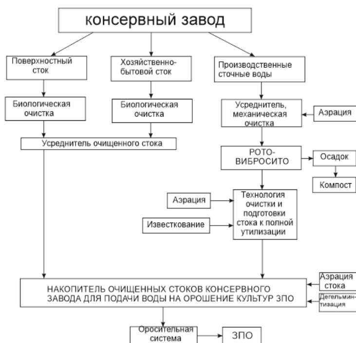
Рисунок 1 – Принципиальная комплексная схема ЛКОС для очистки производственных стоков [3]
