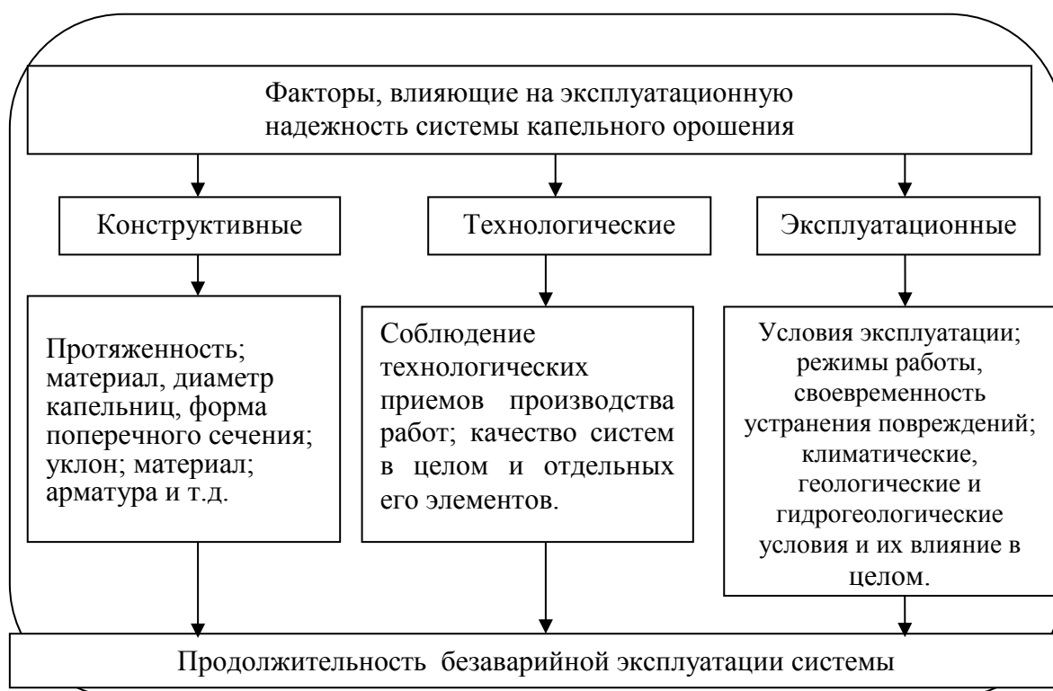
Рисунок 2 – Структурная схема факторов влияющих на продолжительность безаварийной эксплуатации системы капельного орошения
