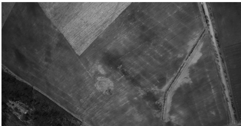
Рисунок 5 Идентификация неисправностей закрытого трубчатого дренажа по данным аэрофотосъемки с беспилотного воздушного судна
