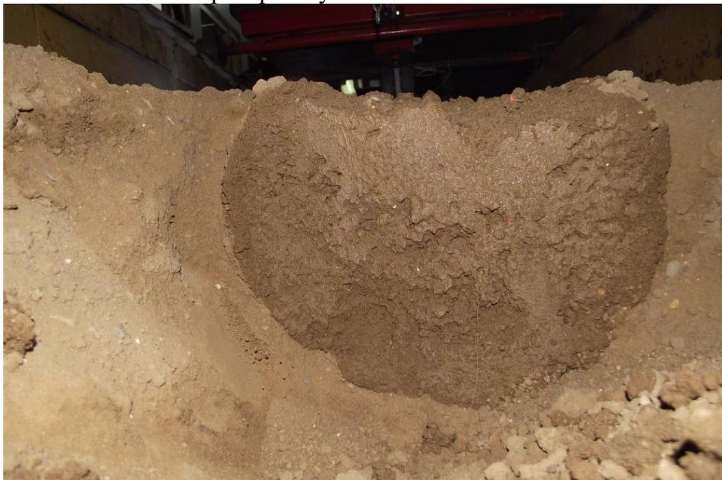
Рисунок 4 –Контур увлажнения капельницы с расходом 2 л/ч.
