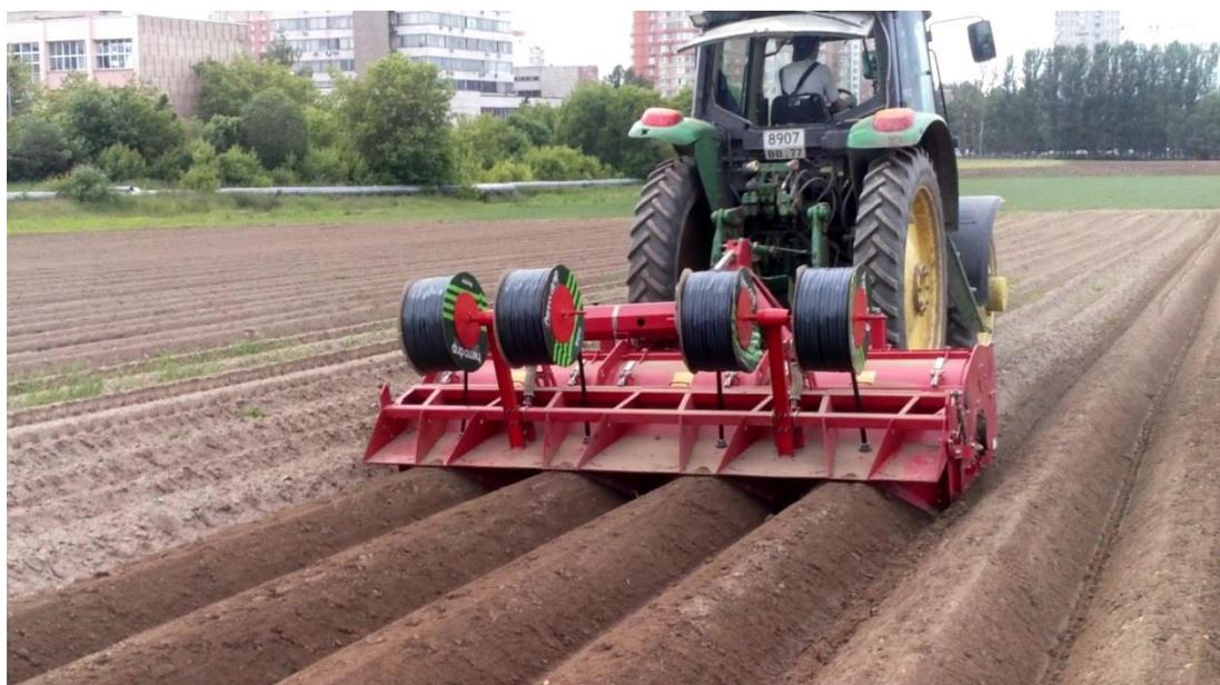
Рисунок 5 – Укладчик капельной ленты на базе гребневателя Grimme75/4
