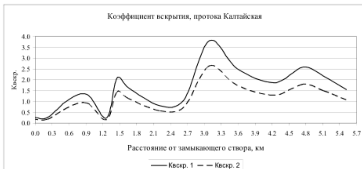
Рис. 3. График распределения K_{вскр} по длине протоки Калтайская при расходе воды в створе с. Синий Утес 5\ 800\ м^3/с ( K_{вскр1} и K_{вскр2} при сопротивлении льда на сжатие 450 и 650 кПа соответственно)
