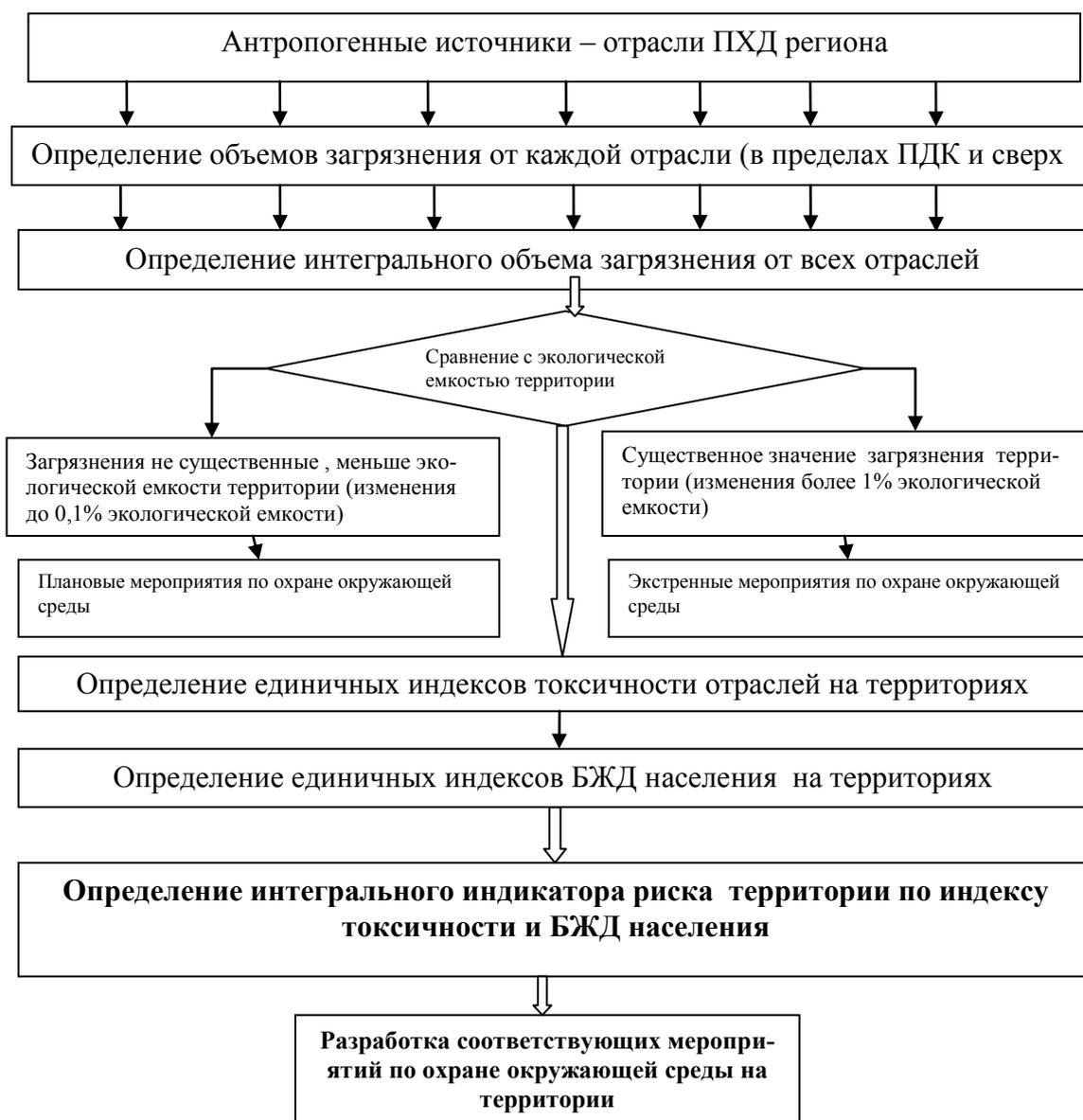
Рис.2. Блок схема экспресс-метода определения интегрального индикатора риска территории
