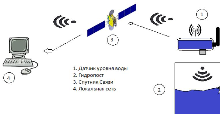
Рисунок 4 – Схема передачи данных датчика уровня воды
