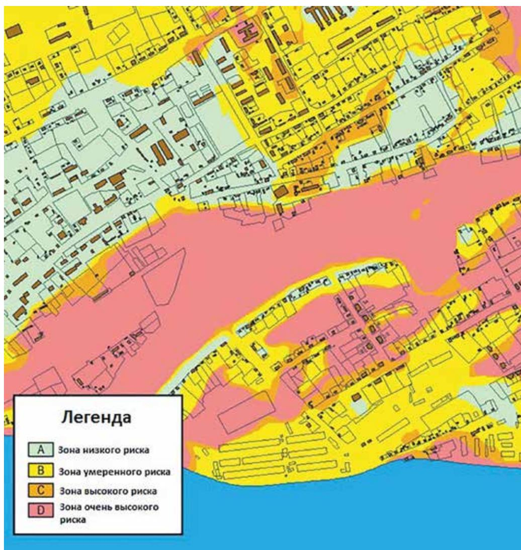
**Рисунок 6.7.** Зонирование территории с. Константиновка (Амурская область) при отсутствии защитной дамбы (фрагмент)
