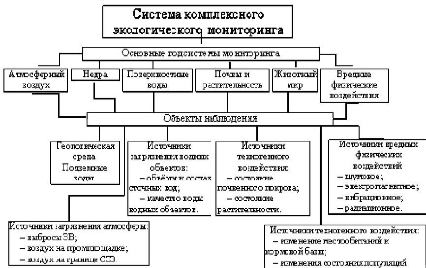
Рис. 1. Блок-схема основных подсистем комплексного экологического мониторинга
