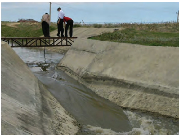
Рис. 4. Опытный образец гидрометрического лотка критической глубины на канале КОР в Дагестане
