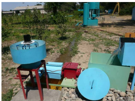
Рисунок 2- Испытание ТСГВ на полигоне КВР в Жамбылской области при поливе яблоневого сада
