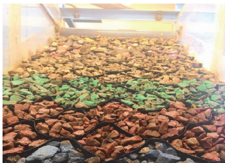
Рис. 1. Вид на модель откоса, укрепленного объёмной георешёткой
