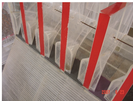
Рис. 3. Физическая модель быков с расширенной кормовой частью и ступенчатой низовой гранью и оголовком, построенным по координатам WES
