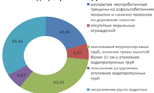
Рис. 3. Результаты обследованных водопропускных сооружений с применением МГС
