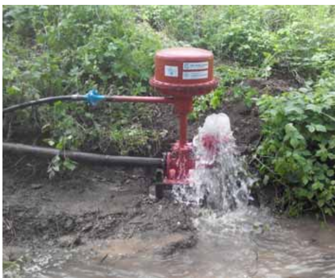
Рисунок – Гидравлический таран КазНИИВХ
