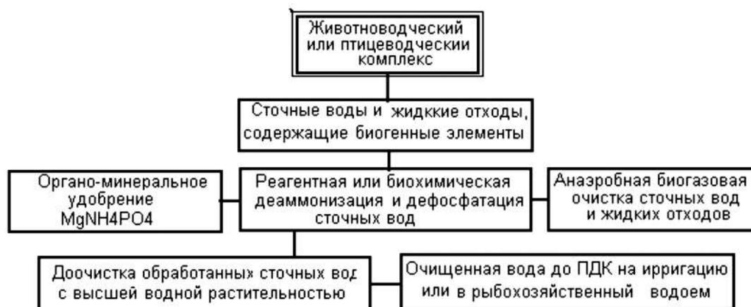
Рис. 2. Схема комплексной очистки сточных вод от биогенных элементов и их использования для орошения сельскохозяйственных культур.
