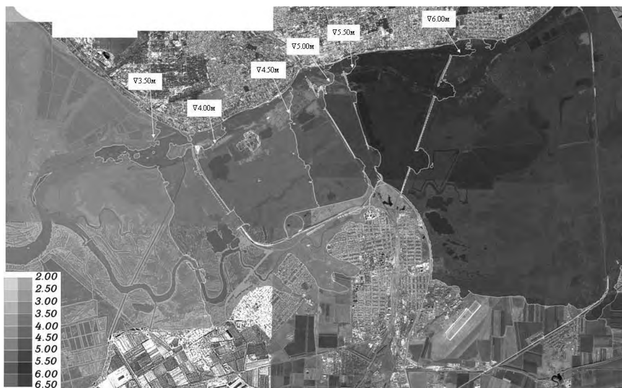
Рисунок 2. Максимальные уровни затопления поймы Нижнего Дона в районе г. Ростов-на-Дону при пропуске 1% половодья, отображенные на космическом снимке
