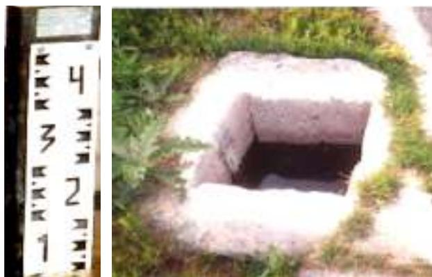
Рис. 31. Успокоительный колодец с равномерной рейкой
