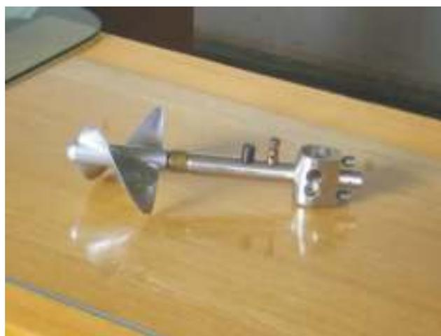
Рис. 32. Гидрометрическая вертушка ГР-21
