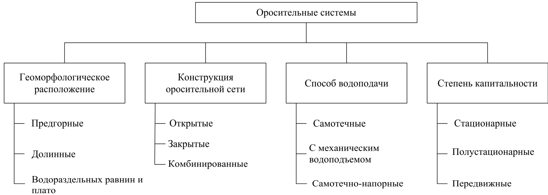
Рисунок 9 – Классификация оросительных систем согласно Б. Б. Шумакову
