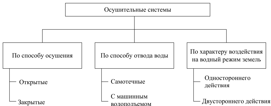
Рисунок 22 – Классификация осушительных систем согласно Мелиоративной энциклопедии
