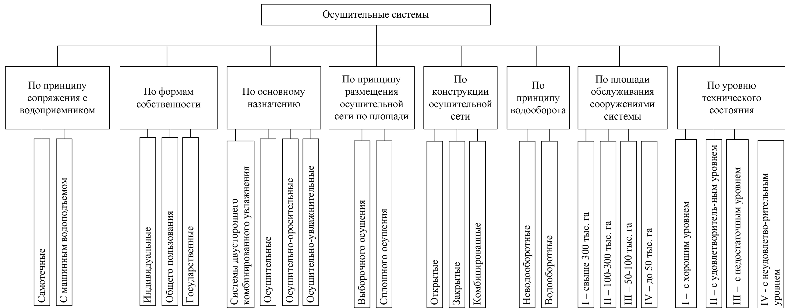
Рисунок 37 – Классификация осушительных систем
