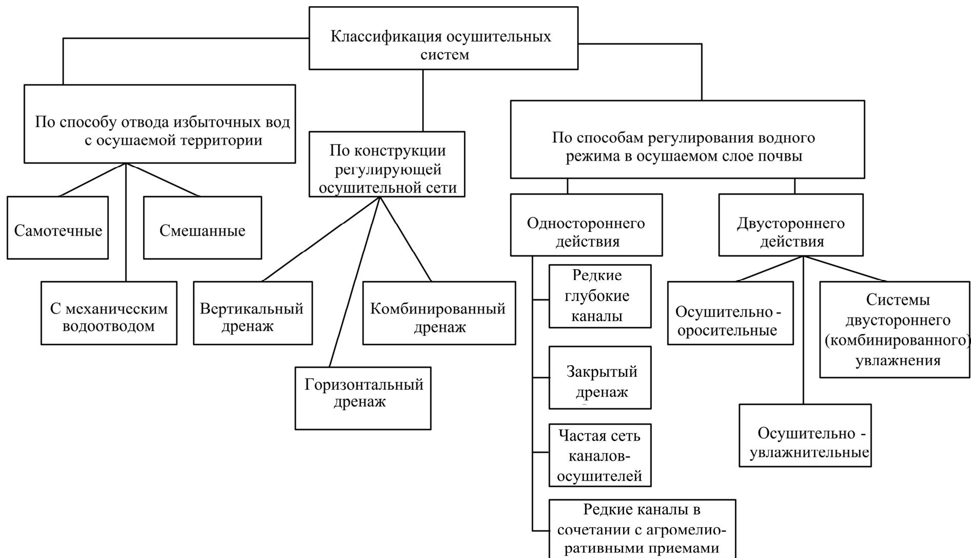
Рисунок 29 – Классификация осушительной системы согласно П. А. Волковскому
