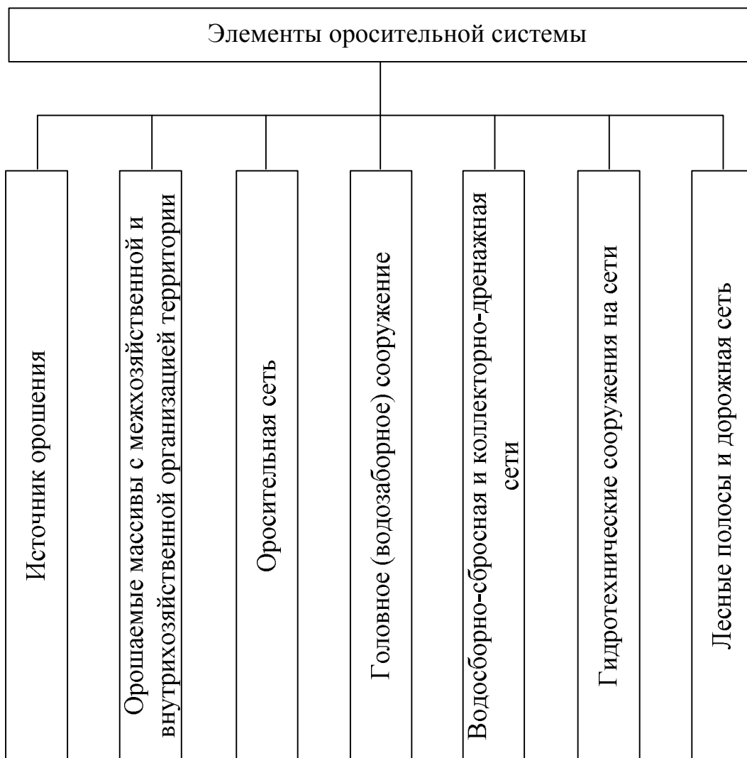
Рисунок 11 – Составные элементы оросительной системы согласно Г. А. Сенчукову
