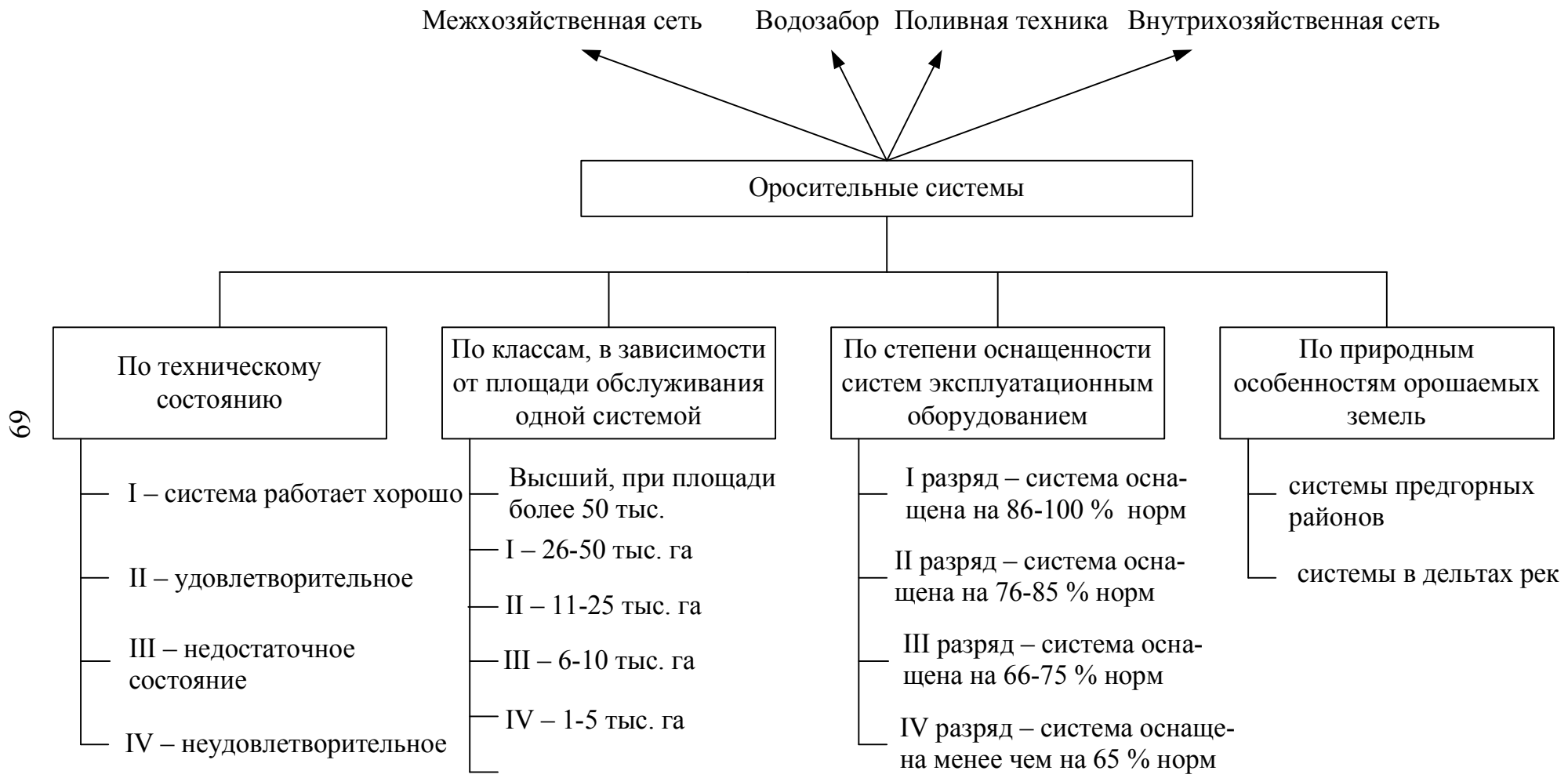
Рисунок 14 – Классификация и элементы оросительных систем согласно М. Ф. Натальчук
