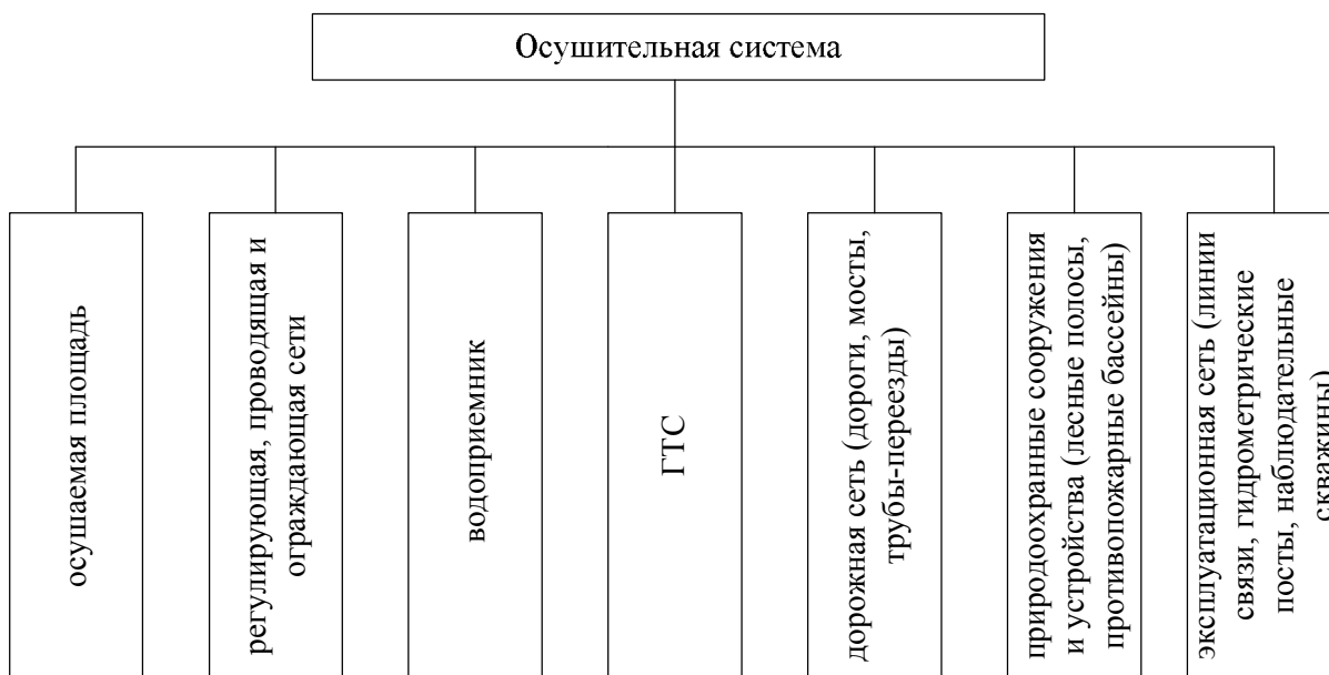
Рисунок 21 – Состав осушительной системы согласно Мелиоративной энциклопедии
