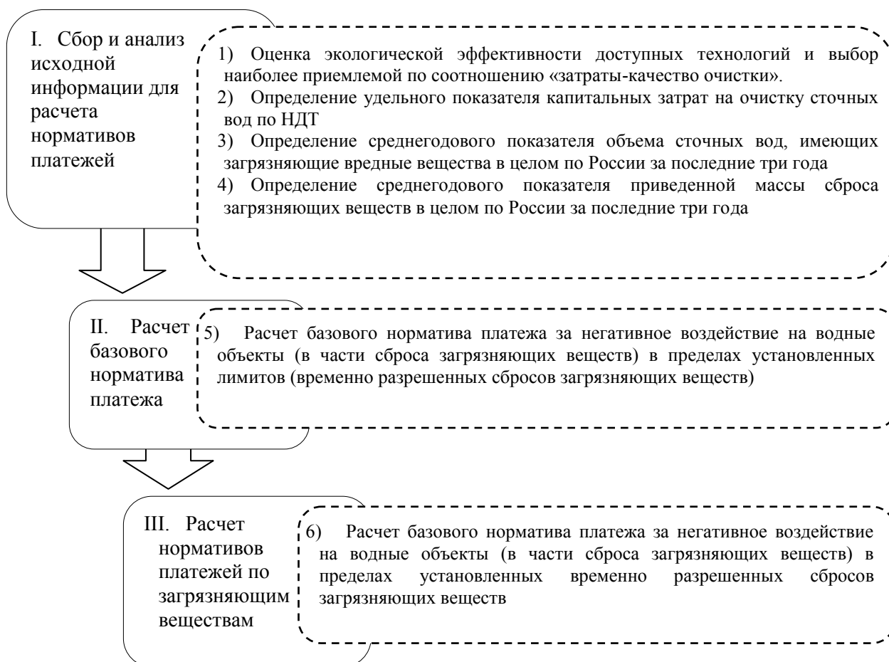
Рисунок. Алгоритм расчета нормативов платежей.
