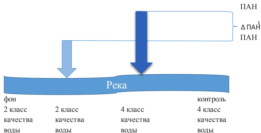
Рис. 4. Принципиальная схема обоснования недопустимого воздействия сбросов (ПАН 1 – показатель антропогенной нагрузки, соответствующий качеству сточных вод, водопользователя, который не ухудшает состояние воды в водном объекте; ПАН 2 – показатель антропогенной нагрузки, соответствующий классу качества сточных вод, водопользователя, который ухудшает состояние воды в водном объекте; Δ ПАН – приращение, характеризующее увеличение антропогенной составляющей за счёт воздействия второго водопользователя).
