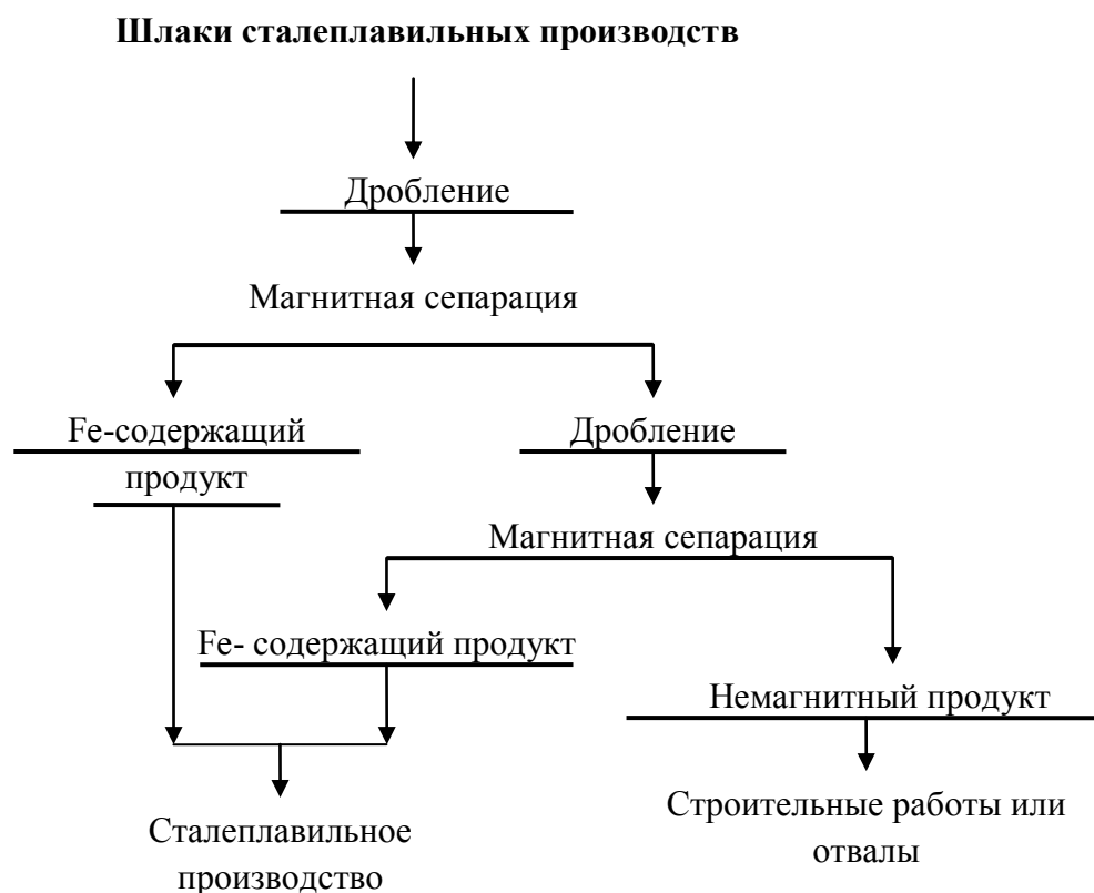
Рис 1. Принципиальная технологическая схема дробильно-сортировочного комплекса.
