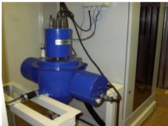
Рис. 3. а – автоматический отбор пробы воды под управлением промышленного компьютера для передачи в рабочую емкость с датчиками; в – рабочая емкость модуля «Коагулянт–Осветлитель» с датчиками мутности, величины рН, температуры.
