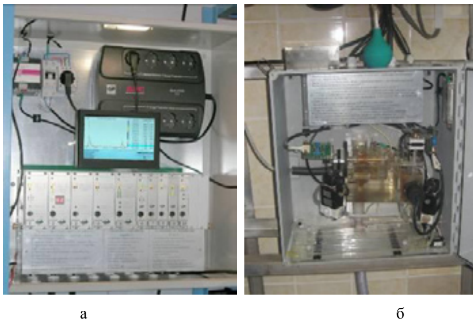
Рис. 14. КИМ «Хлор–Мониторинг»: а – блок измерения и управления; б – блок автоматических дозаторов с фотометрическим блоком индикации.
