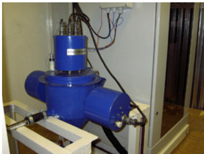
Рис. 3. НФС-1 МУП г. Новосибирска «Горводоканал»: а – блок приема и распределения потоков КИМ «Коагулянт–Осветлитель». Поступление выбранной компьютером пробы воды в приемную воронку модуля; б – рабочая емкость с датчиками.
