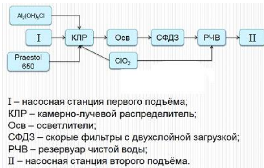
Рис. 1. Предлагаемая традиционная схема водоподготовки. Вариант 1.
