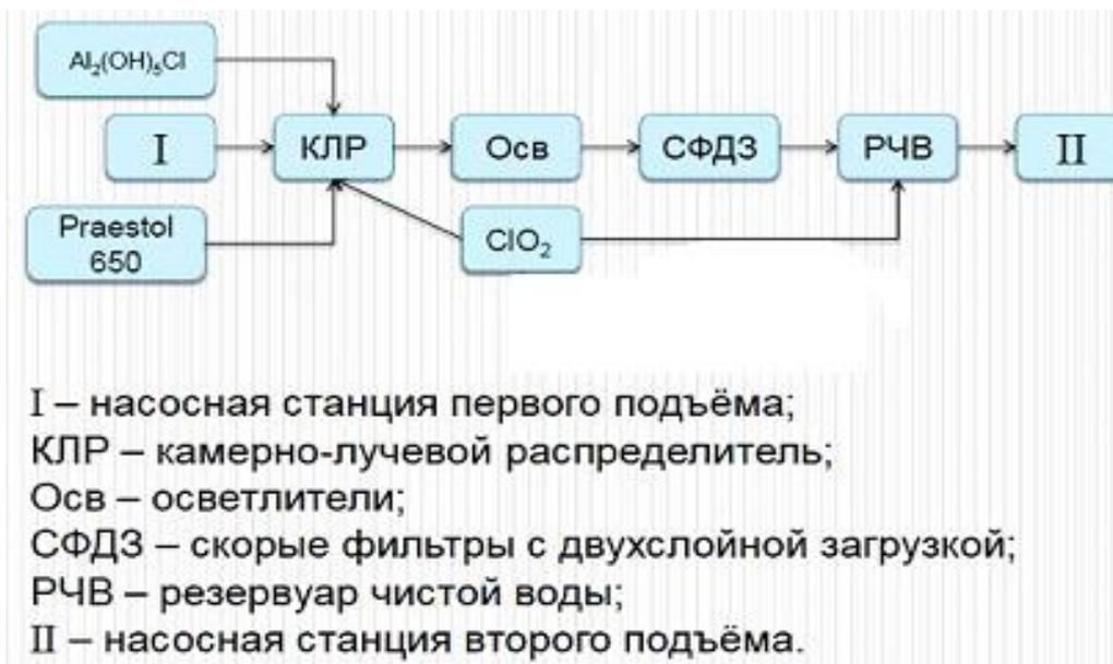
Рис. 1. Предлагаемая традиционная схема водоподготовки. Вариант 1.
