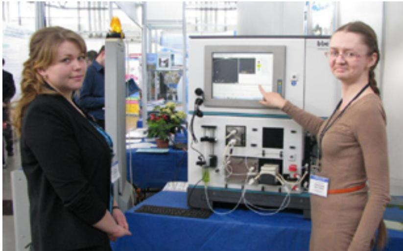
**Рис. 1.** Система биосигнализации с использованием дафний (*Daphnia magna*) DaphTox
