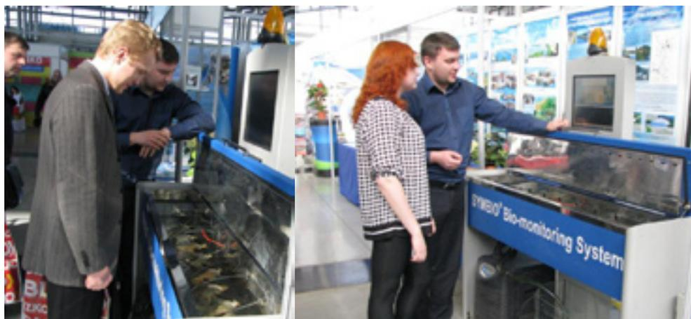
**Рис. 3.** Система биосигнализации с использованием двустворчатых моллюсков (*Unio pictorum*)
