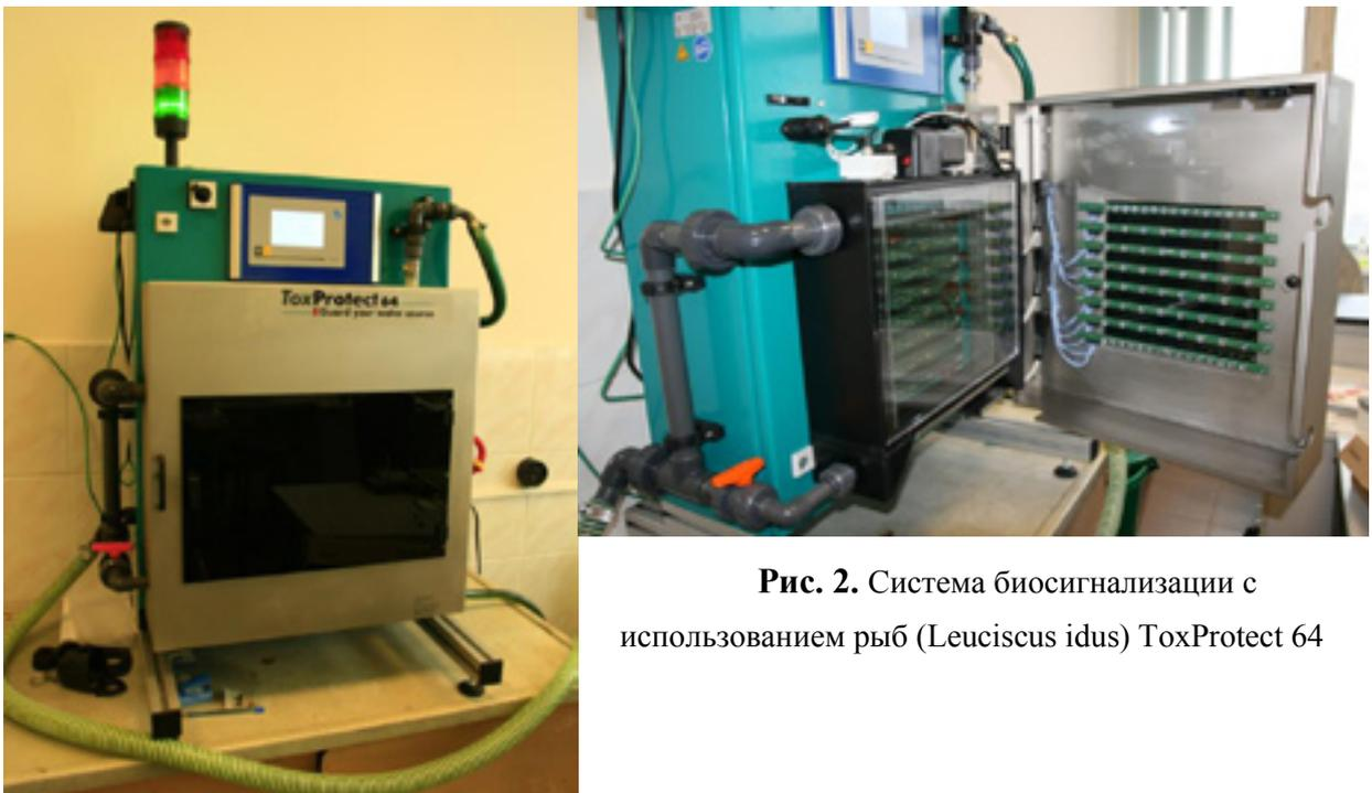
**Рис. 2.** Система биосигнализации с использованием рыб (*Leuciscus idus*) ToxProtect 64
