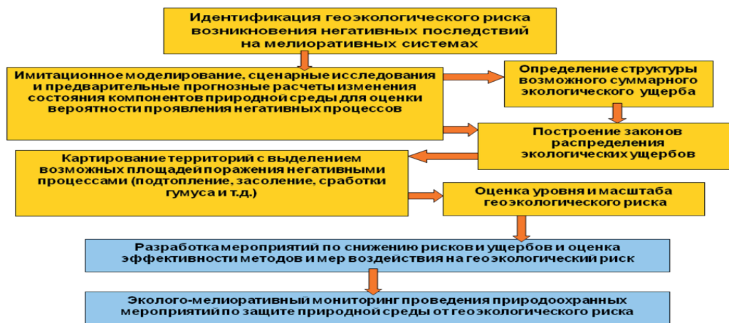
Рис. 3. Структурная схема управления геоэкологическими рисками на оросительных системах нового поколения
