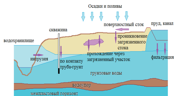
Рис. 1. Схема поступления загрязняющих веществ в подземные горизонты
