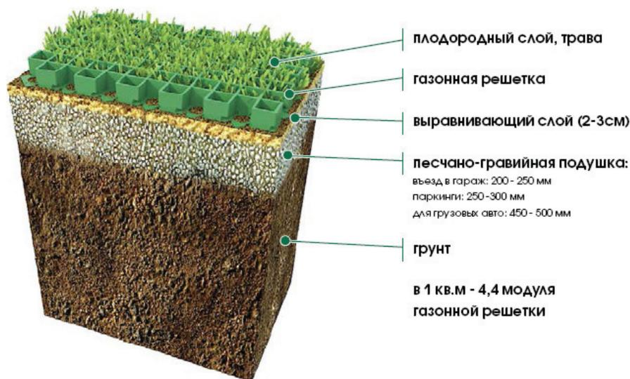
Рис. 1. Схема конструкции с газонными решётками
