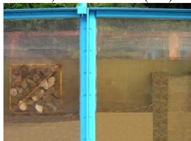
Рис. 6. Сооружение с «козырьком», высотой 5 см (2 м)
