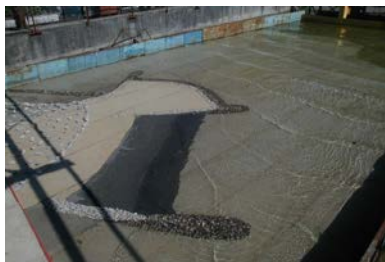
Рис. 2. Модель в волновом бассейне искусственной территории и пляжа под прикрытием каменно-набросных бун в г. Анапа
