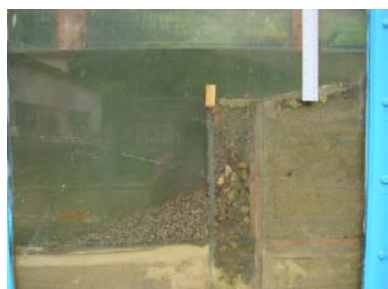
Рис.10. Сооружение с «козырьком», высотой 2,5 см (1 м)
