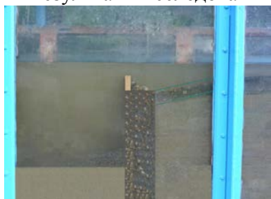
Рис. 6. Сооружение с «козырьком», высотой 5 см (2 м)
