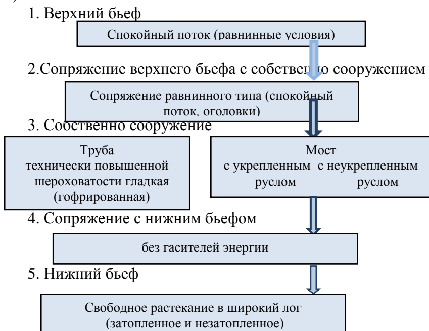
Рис. 6. Классификация применяемых равнинных сооружений по условиям их гидравлической работы
