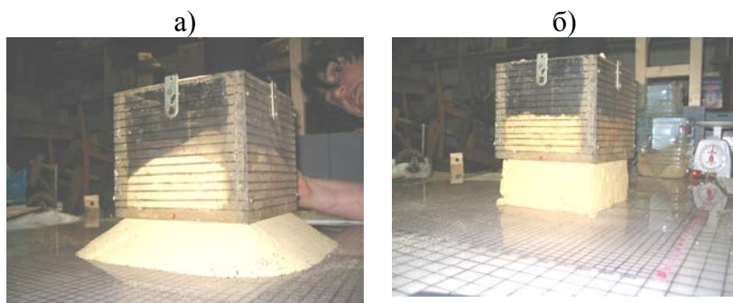
Рис. 7. Взаимодействие каркаса и засыпки грунта ячейки; а – при естественной влажности грунта; б – при влажности грунта выше естественной (влажность 5% по весу грунта)
