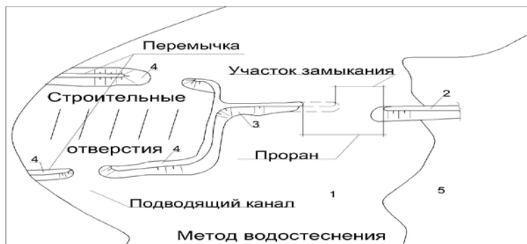
Рис. 2. Метод водостеснения: 1 – русло реки; 2, 3 – пионерные дамбы; 4 – перемычки; 5, 6 – правый и левый берег
