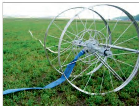
Рис 9.12. Унифицированная тележка передвижного поливного комплекта ППК-25:
