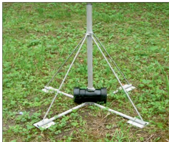
Рис. 5.8. Установка стоеки в муфте
