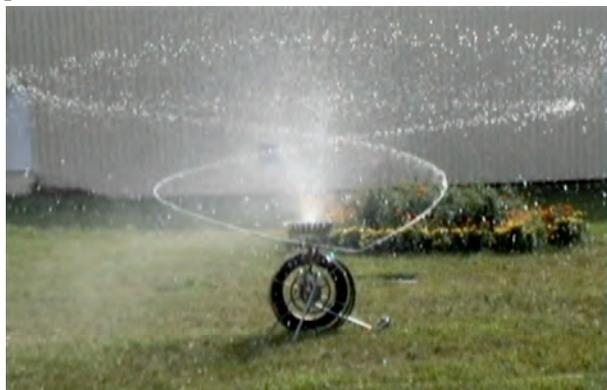
Рис. 7.7. ДШ-1 в режиме струйного орошения в движении
