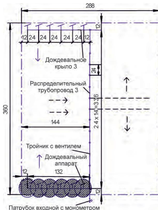
Рис. 5.3. Типовая схема орошения комплектом КИ-10 ( $F_{op}=10,4$  га)
