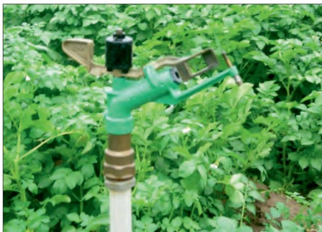
Рис.5.7. Дождевальная головка на стоеке
