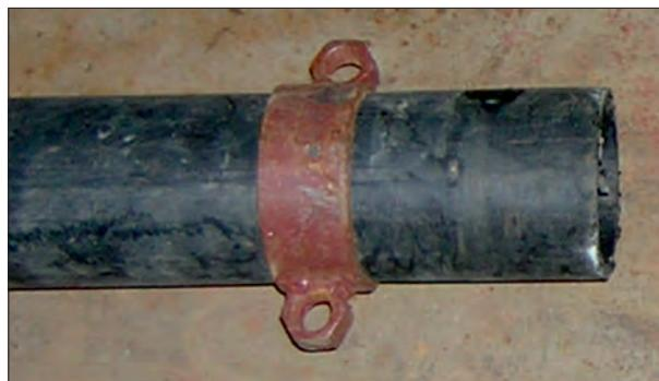
Рис.5.10. Установка хомута на трубе
