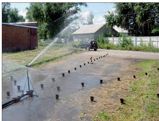
Рис. 1.9. Контроль характеристик дождя аппарата ДКШ-64
