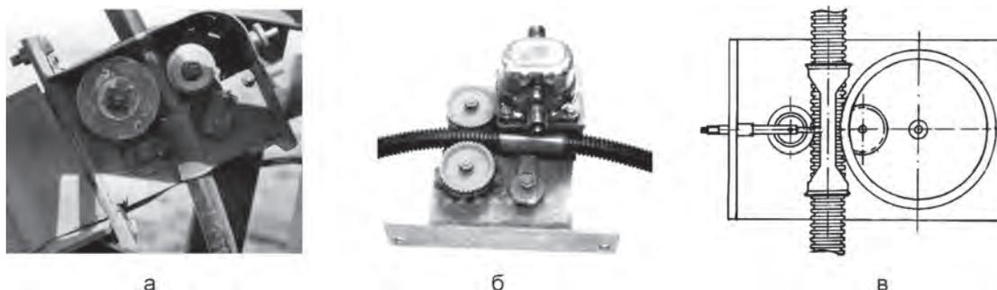
Рис. 10.5. Перфоратор для полиэтиленовых труб:
