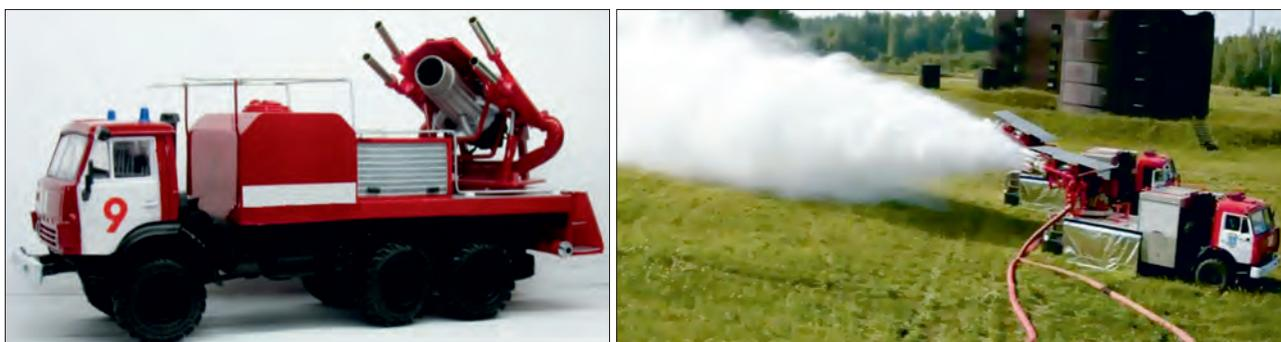
Рис. 6.20. Автомобиль газоводяного тушения АГВТ-150
