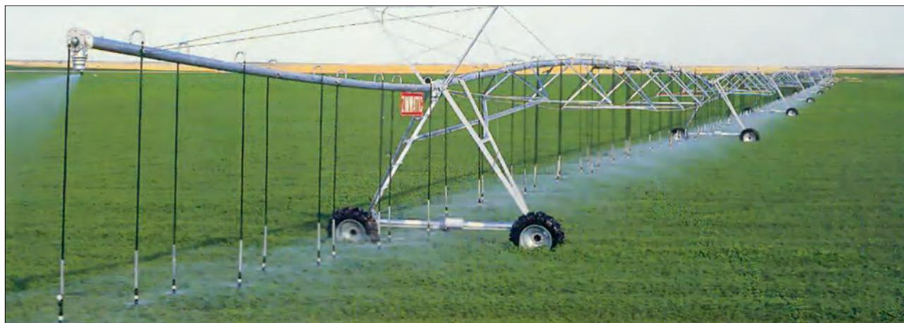
Рис. 6.21. Микродождевальные насадки в работе на машине «Zimatic» (Франция)
