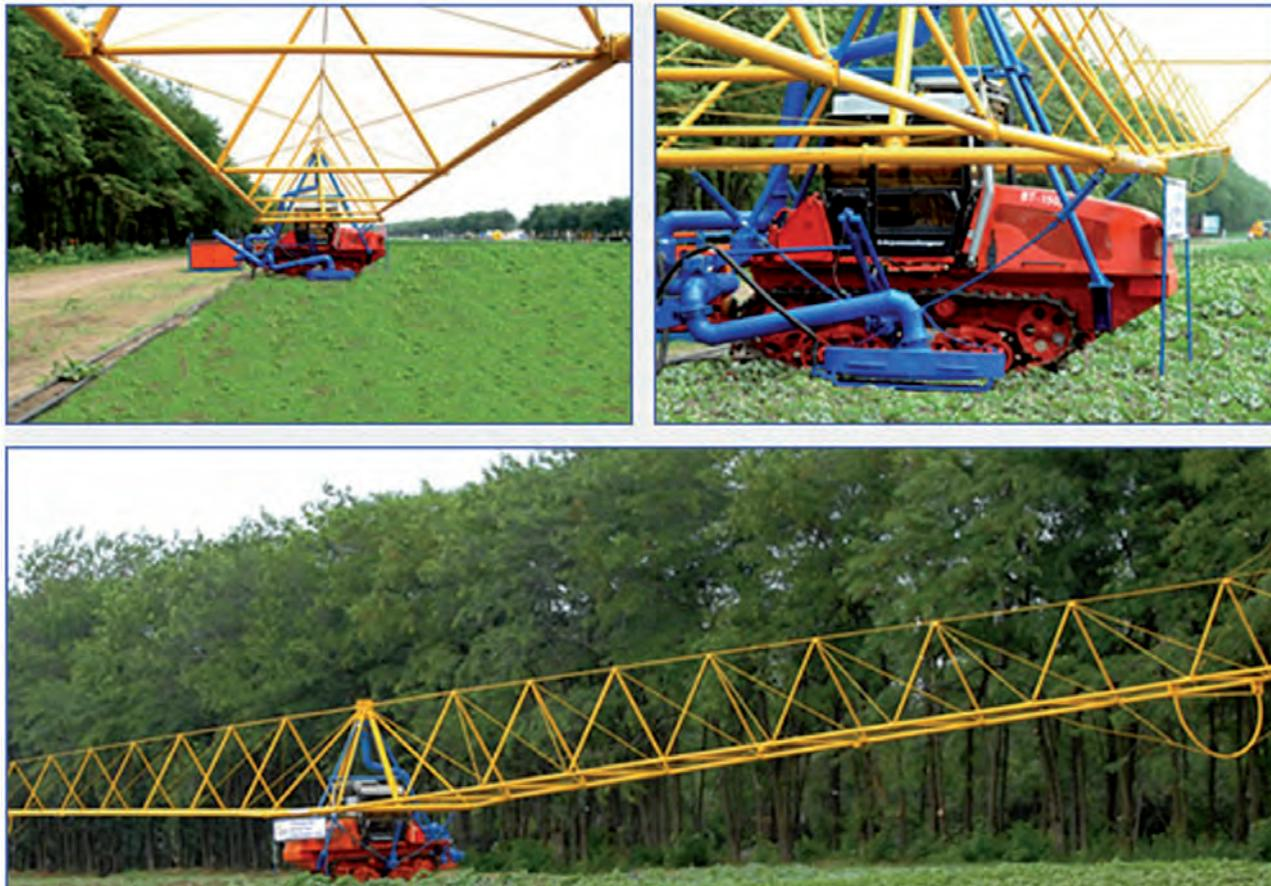
Рис. 3.38. Дождевальный агрегат ДДА-100В
