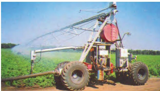
Рис. 3.10. Общий вид дождевальной машины «Ладога»
