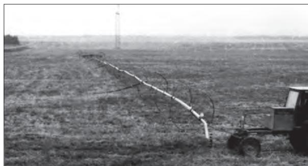
Рис. 9.9. Трубопровод колёсный универсальный ТКУ-100
