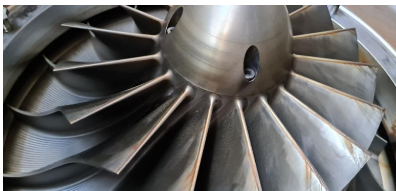
Рис. 2- Налет на поверхности лопаток турбокомпрессора в виде «битумных» пятен (цех карбамид-3 ОАО Гродно Азот – 2022 год).
