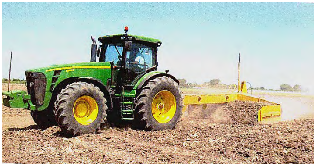
Рисунок 3 - Планировщик ПАУ-2 с лазерной системой в работе [3]
