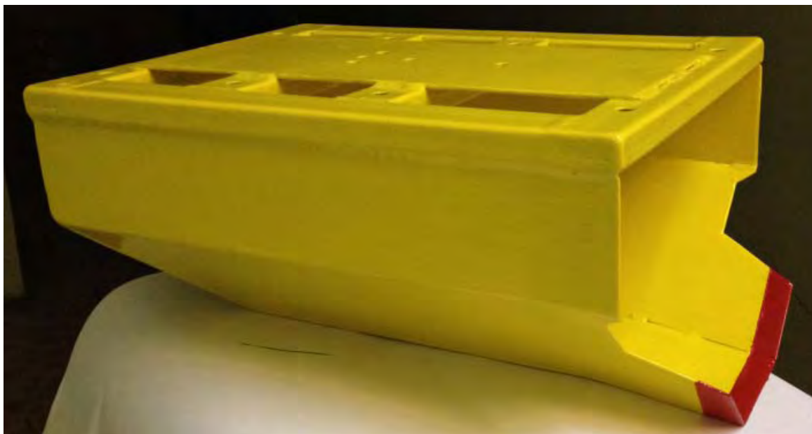
Рисунок 4 - Модель ковша каналочистителя РР-303 с трапецеидальным сечением
