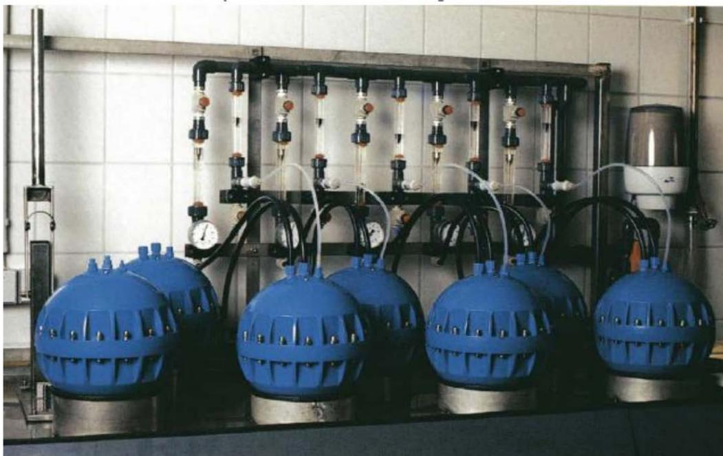
Рисунок 1 - Система очистки воды группой параллельно работающих мембранных диско-трубчатых модулей
