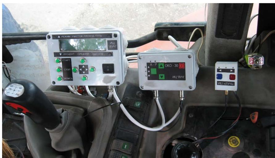
Рисунок 4 – Совмещение в кабине трактора пультов управления, слева направо: автонивелера АН-3, лазерно-приемного устройства ОКО-30, курсового навигатора КН-1 и актуатора АК-1
