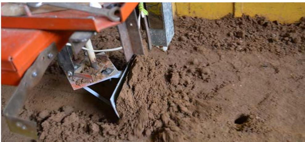
Рисунок 2 - Процесс копания грунта бульдозерным отвалом на экспериментальной установке
