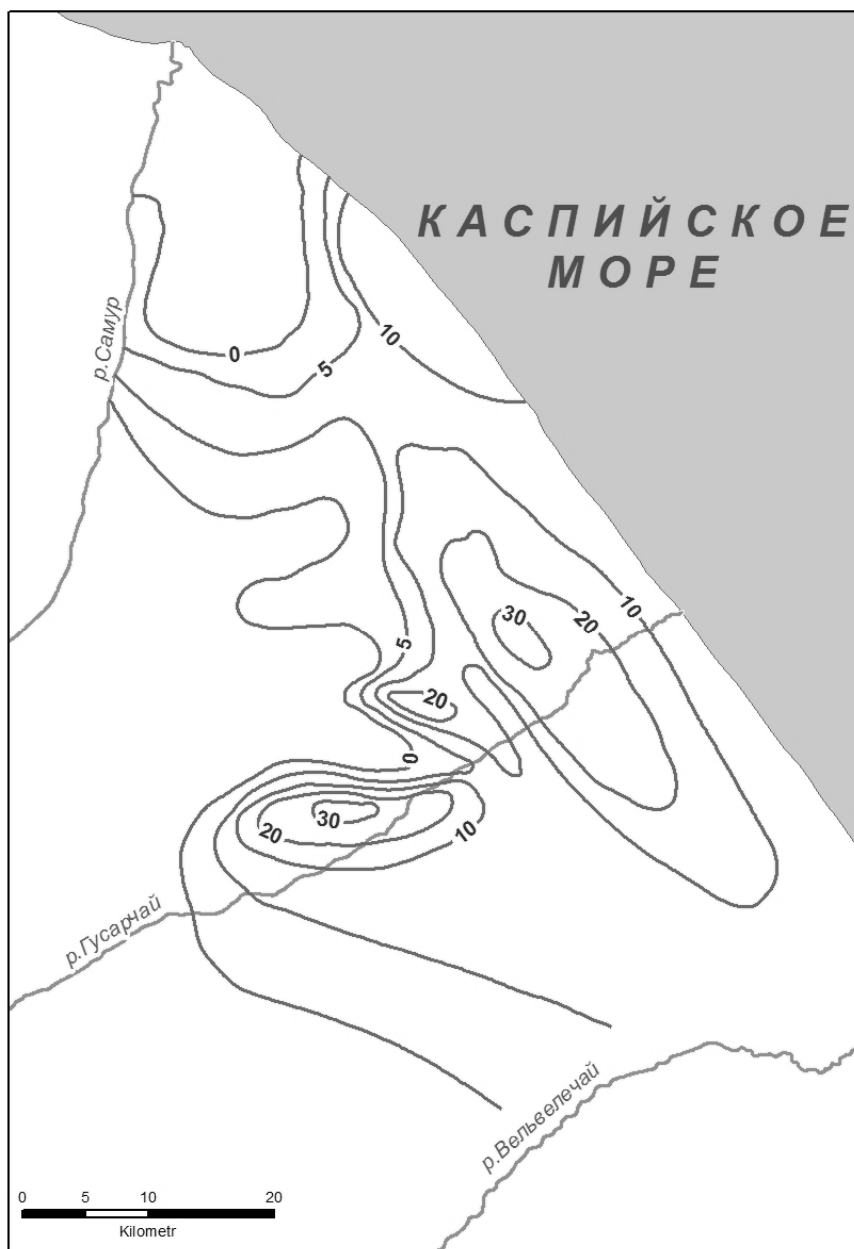
Рис. 2. Схематическая карта напоров подземных вод над кровлей водовмещающих пород (изолинии в метрах)
