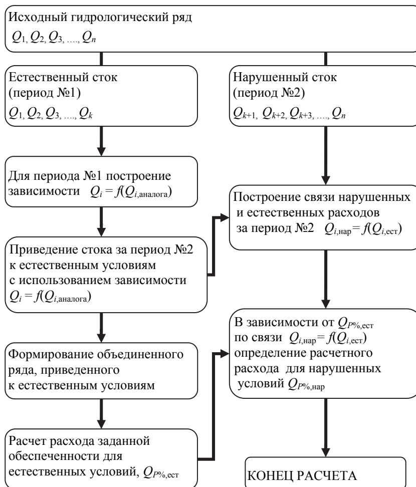
Рис. 2. Блок-схема расчета расходов воды для нарушенных условий (вариант с восстановлением естественного стока).
