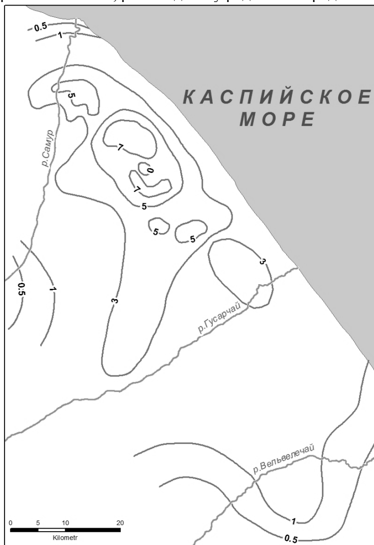
Рис.1. Схематические карты водопроводимости хвалинско-хазарского-бакинского-гусарского водоносного комплекса (изолинии в тыс.м 2 /сут.)
