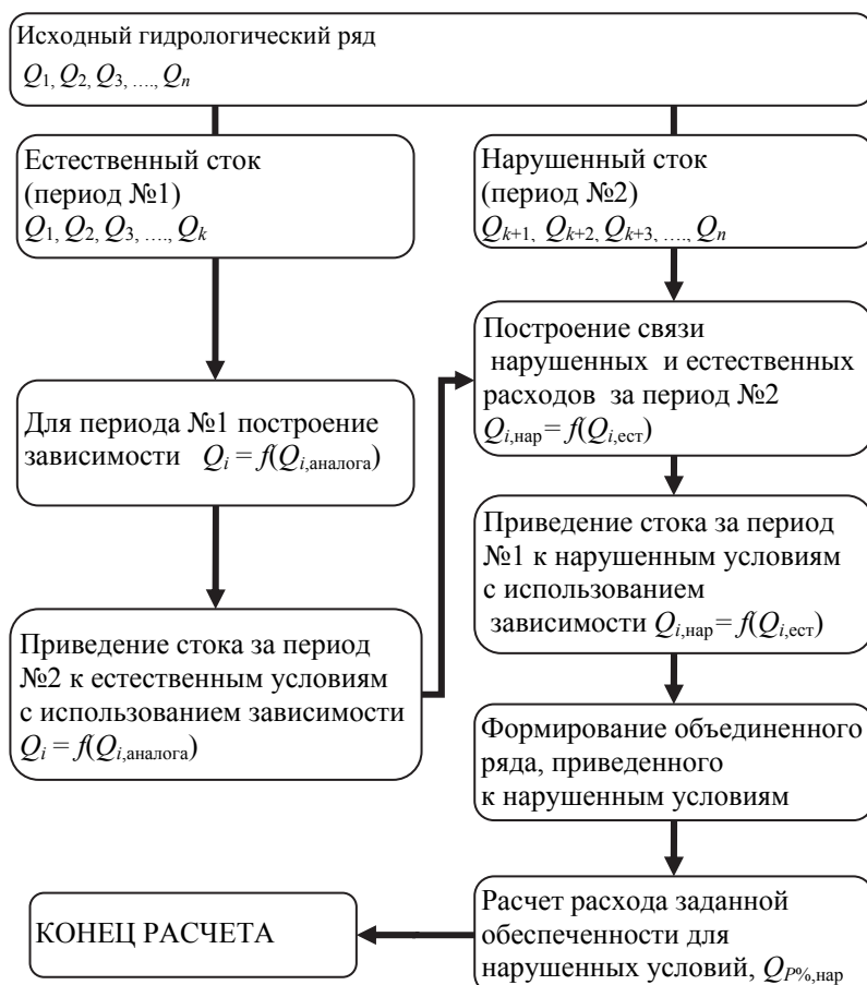
Рис. 5. Блок-схема расчета расходов воды для нарушенных условий (вариант с приведением ряда к нарушенным условиям).
