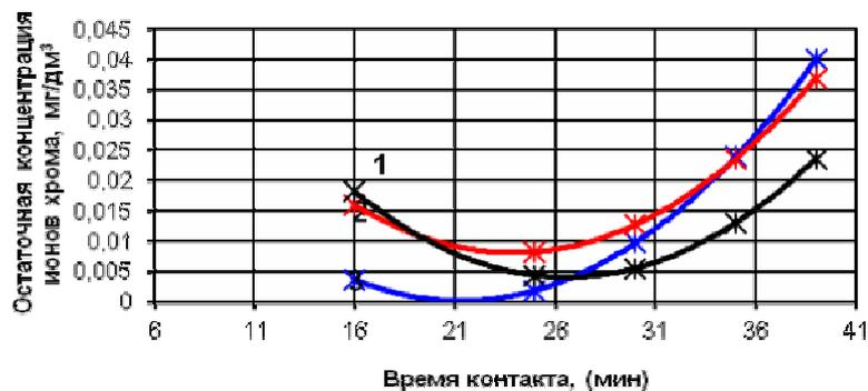
*Рис. 1.* Зависимость остаточной концентрации ионов хрома от времени контакта.
