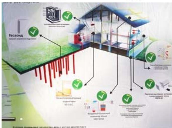
Рис.2. Схема основных устройств энергоэффективного дома.
