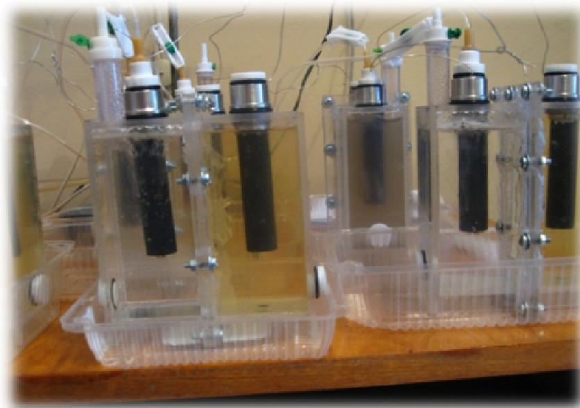
*Рис. 1.* Фото экспериментальных МТЭ разработанных НИВЦ «Энергофизика» А. Ф. Лашиным.
