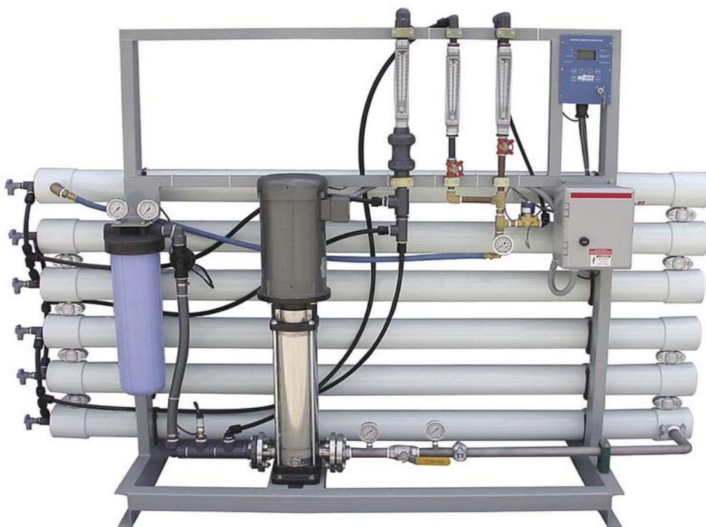
*Рис. 2.* Промышленная установка нанофильтрации воды.
