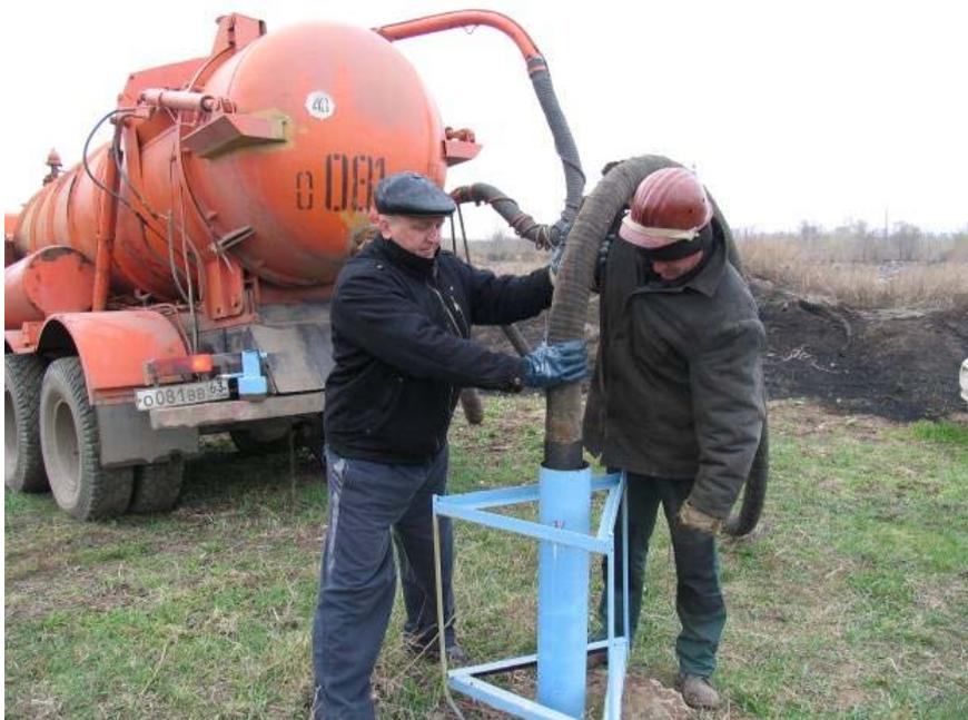
Рис. 2. Закачка осадка в экспериментальную скважину полигона.
