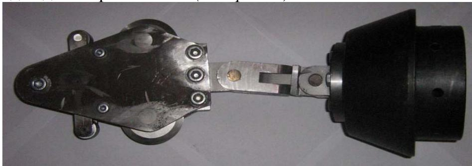
Рис. 2. Опытный образец рабочего механизма для бестраншейного ремонта криволинейных трубопроводов диаметром 150 мм.
