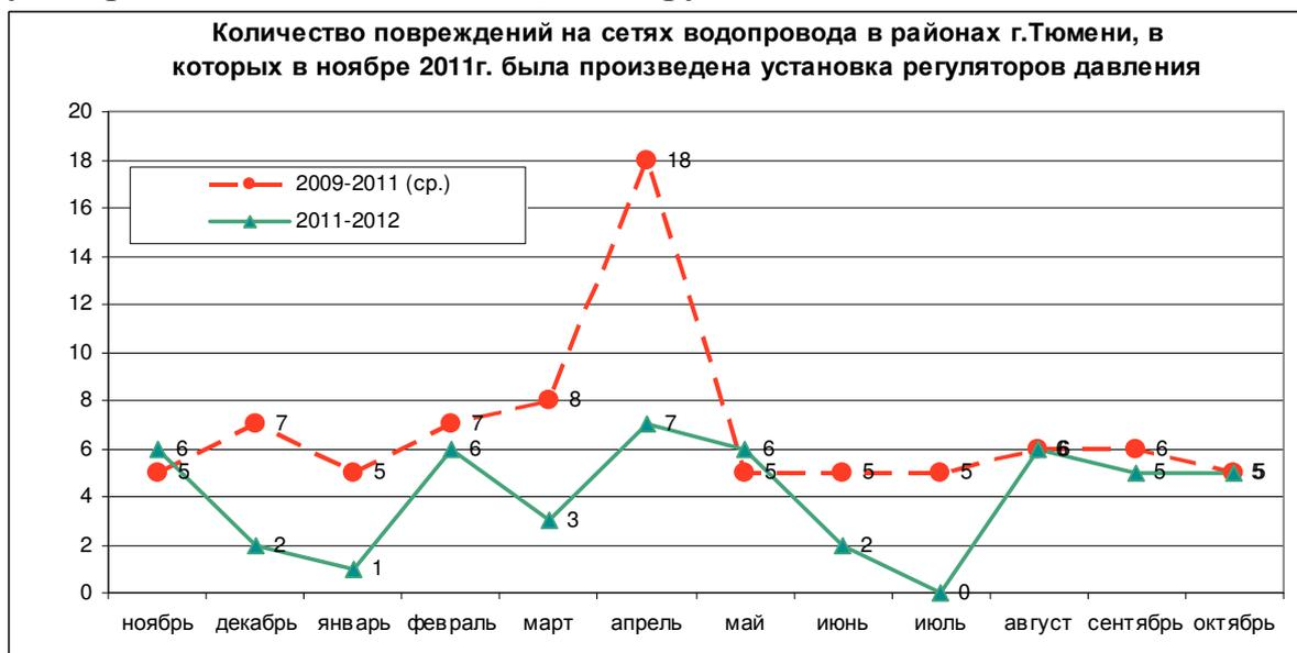
Рис. 6. Количество возникновения новых повреждений на сетях в районах установки регуляторов давления на 2009-2012 гг.
