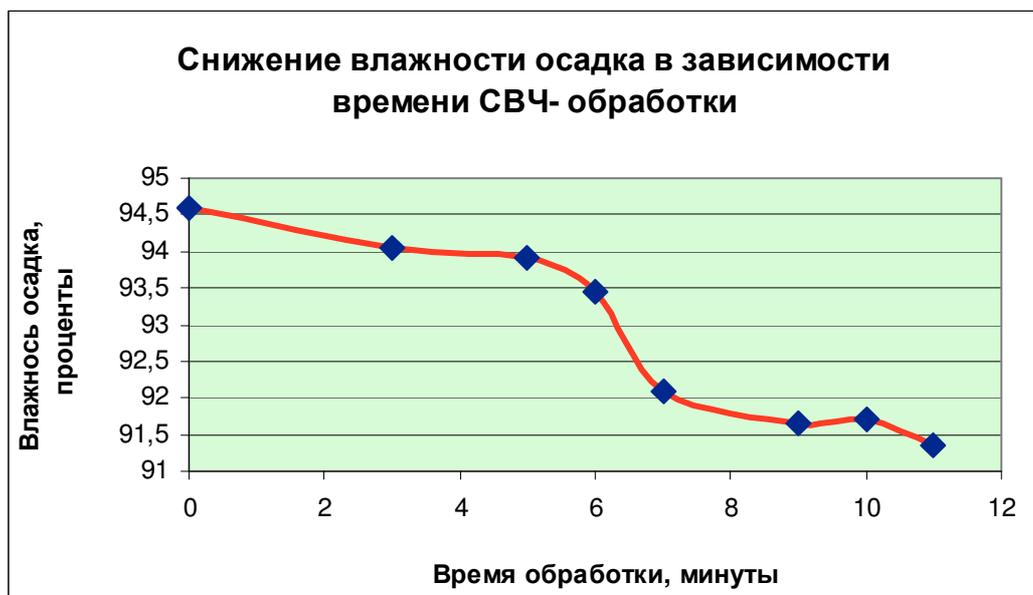
Рис. 2. Снижение влажности осадка в зависимости времени СВЧ-обработки.
