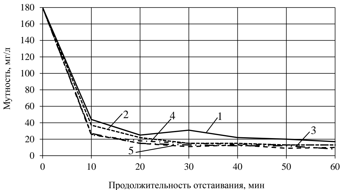
Рис. 4. Влияние вида и дозы реагентов на эффективность осветления промывной воды в весенний период (май, р. Тура): 1 – без реагентов; 2 – СА (12 мг/л)+ОХА (6 мг/л); 3 – СА (12 мг/л)+ОХА (6 мг/л)+ПАА (0,5 мг/л); 4 – СА (12 мг/л)+ОХА (6 мг/л)+ПАА (1 мг/л); 5 – СА (12 мг/л)+ОХА (6 мг/л)+ПАА (1,5 мг/л)
