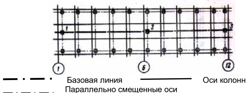
Рис. 2. Развитие поэтажной основы 21-этажного здания «Националь»
