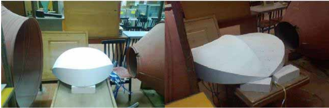
Рис. 1. Макеты криволинейных сооружений, установленные в аэродинамической трубе
