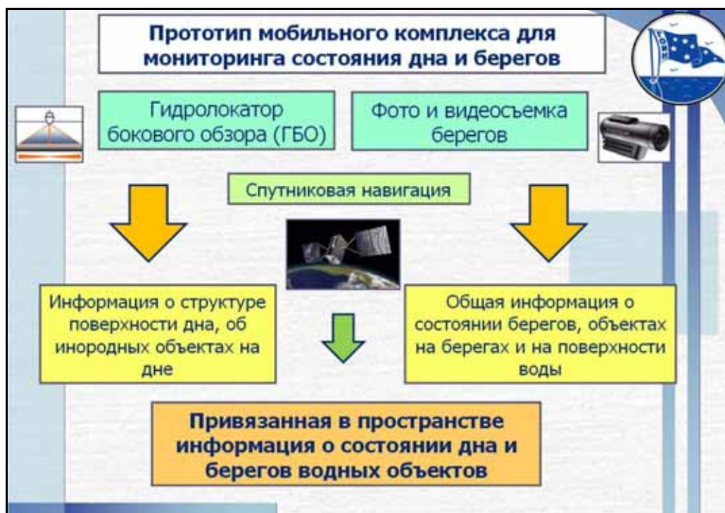
Схема прототипа мобильного приборного комплекса (ФГБУ «ГОИН»)
