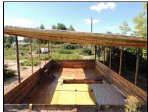
Рис. 1а. Общий вид испытательной площадки. Размеры площадки в плане 5х9 м, заглубление 0,8 м
