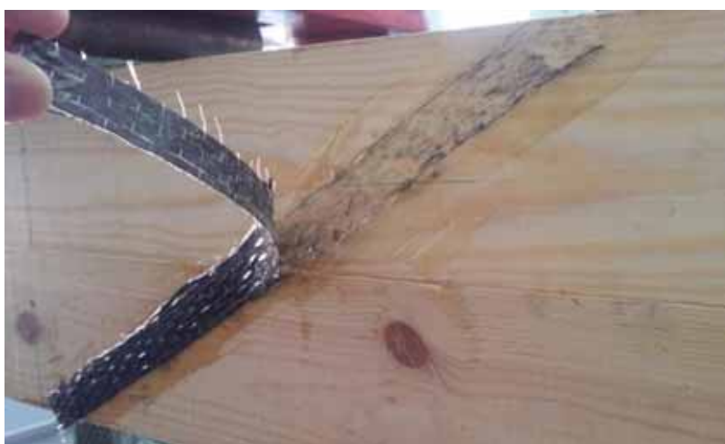
Рис. 5. Фотография образца испытанного по двухточечной схеме
