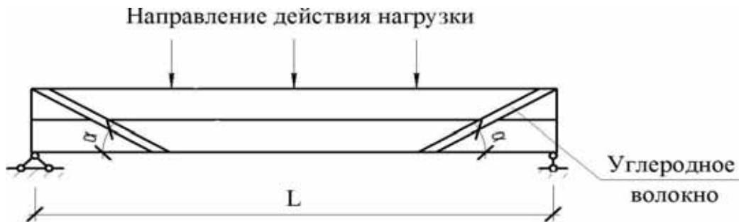
Рис. 1. Схема усиления деревянных конструкций
