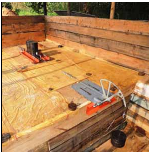
Рис. 2. Общий вид экспериментальной установки во время испытаний модели фундамента из 4 линейно расположенных свай.
