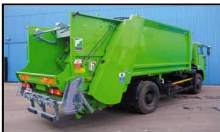
Рис. 2. Мусоровоз МСТ-6963-50 на шасси КАМАЗ-53605
