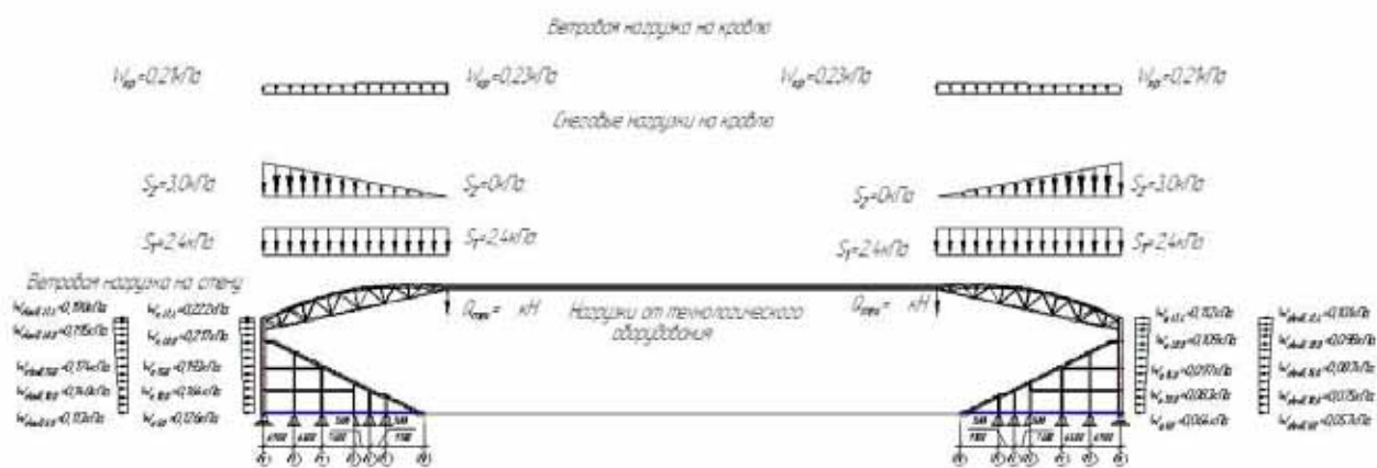
Рис.2. Схема нагрузок, действующих на конструкции стадиона
