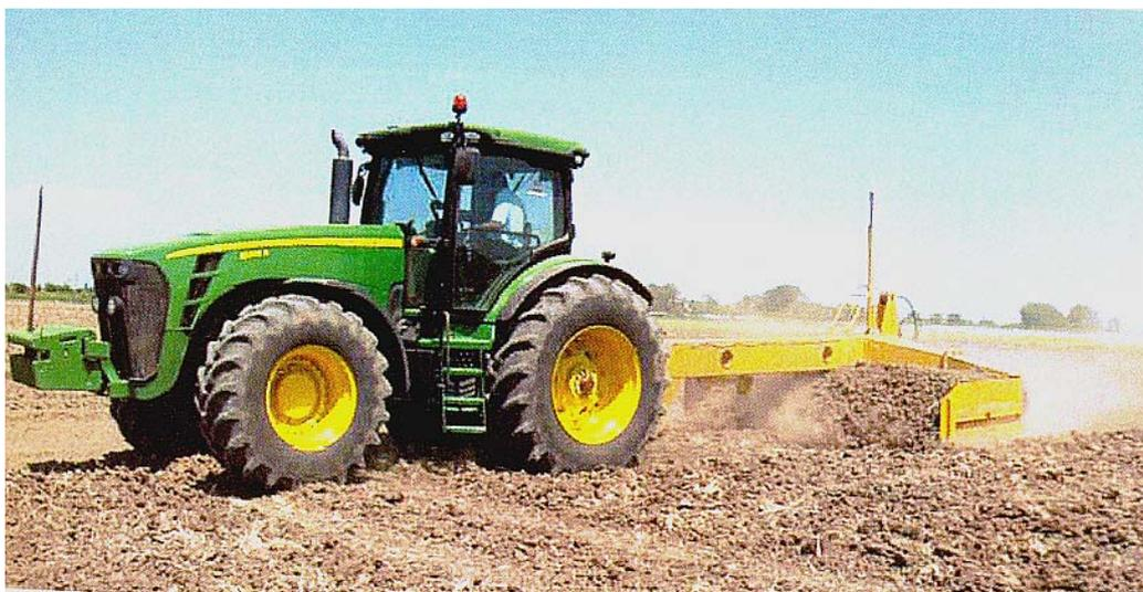
Рисунок 3 - Планировщик ПАУ-2 с лазерной системой в работе [3]
